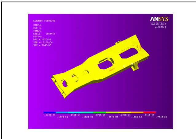
Figure IV-49a. Déformation suivant z
