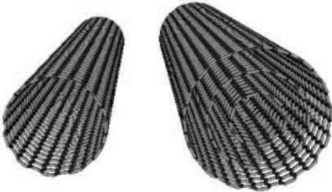
**Figure (II.2) :** Structures moléculaires d'un nanotube de carbone à paroi simple (à gauche) et d'un nanotube de carbone à parois multiples (à droite).
