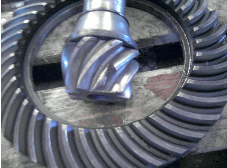
Figure 6 : Pignon endommagé après fonctionnement
