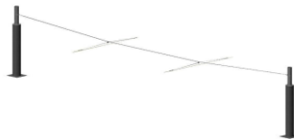
Figure II. 18 Support bilatéral avec suspension sous transversal
