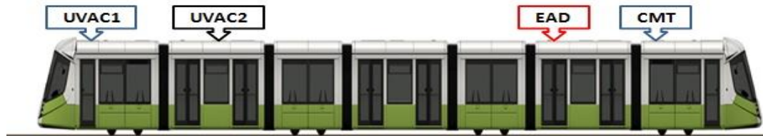
Figure III. 14 Vue de côté de la rame Citadis 402 avec positionnement des principales sources acoustiques intrinsèques
