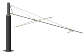
Figure II. 19 Poteau unilatéral avec suspension sous console double voie
