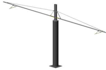
Figure II. 20 Poteau central avec suspension sous consoles simple voie
