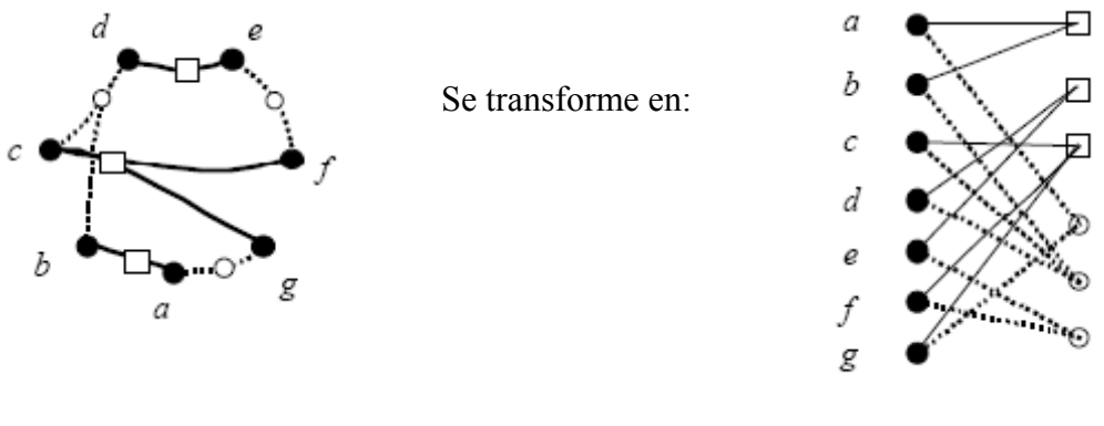
Figure 3.13: Une transformation d'un hypergraphe vers un graphe biparti [Sopena]
