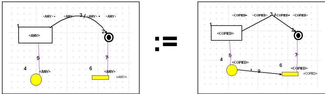
Figure 5.23: Transformation d'une transition entre un état simple et un état final
