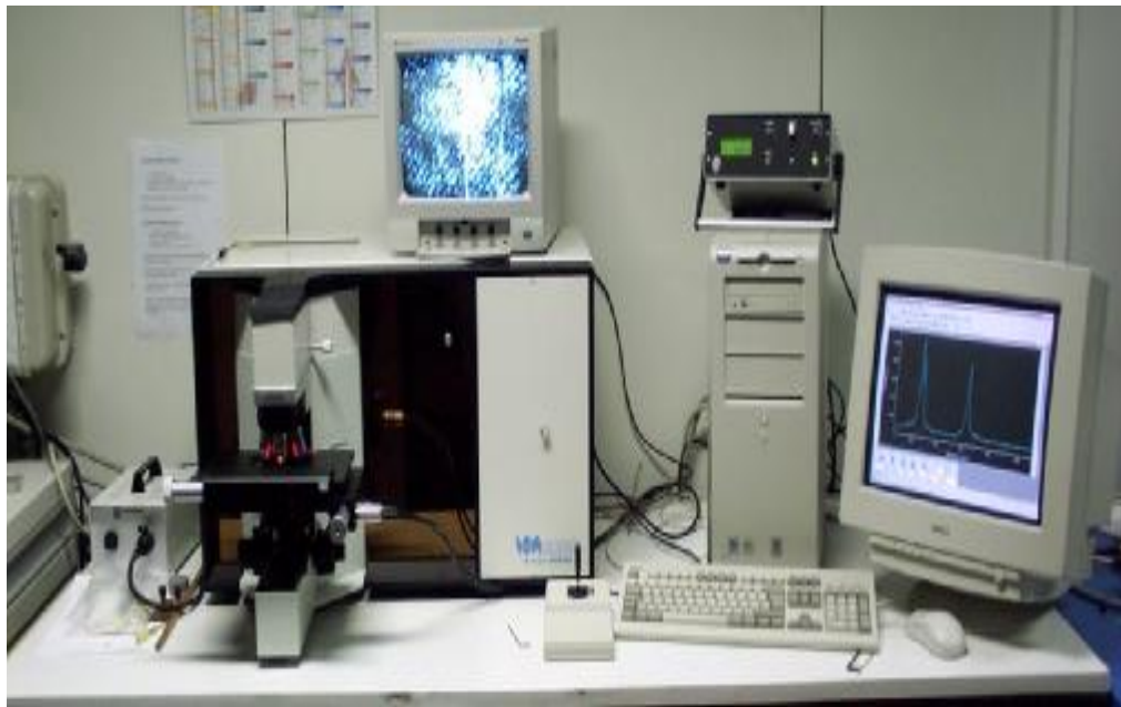
Figure 24 : Dispositif expérimental de la retro-diffusion ( \mu -Raman)
