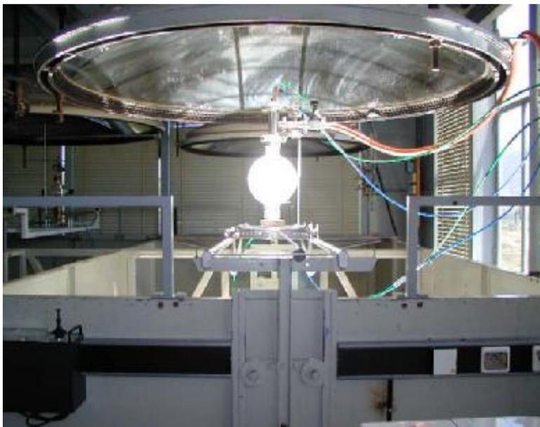
Figure II-1a: Réacteur SPVD au foyer d'un four solaire de 2kW à concentrateur parabolique. (Laboratoire PROMES à Odeillo/Font Romeu, France)
