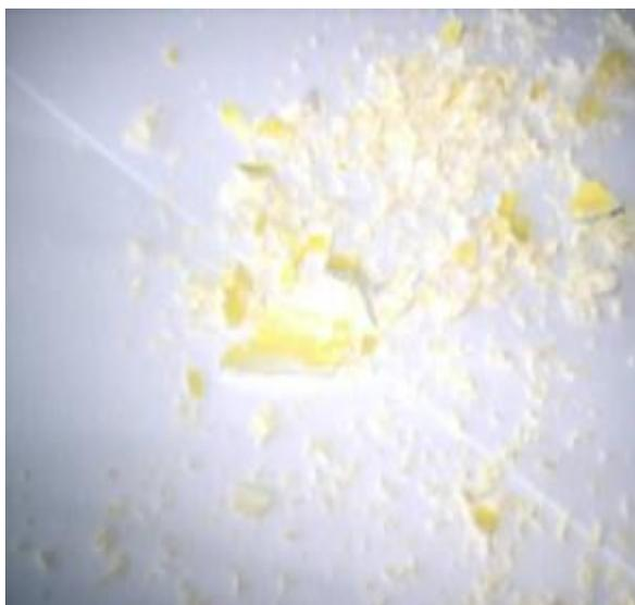
Figure (II-5c): Aspect des poudres de ZnO dopée à l'oxyde de bismuth préparées par SPVD.
