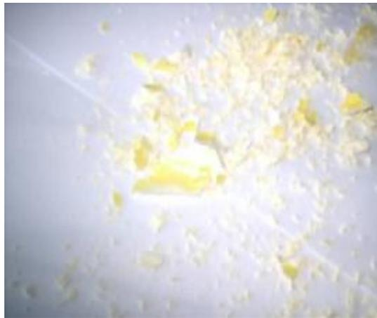
Figure (III-36): Aspect des poudres de ZnO dopée par l'oxyde de bismuth préparées par SPVD.
