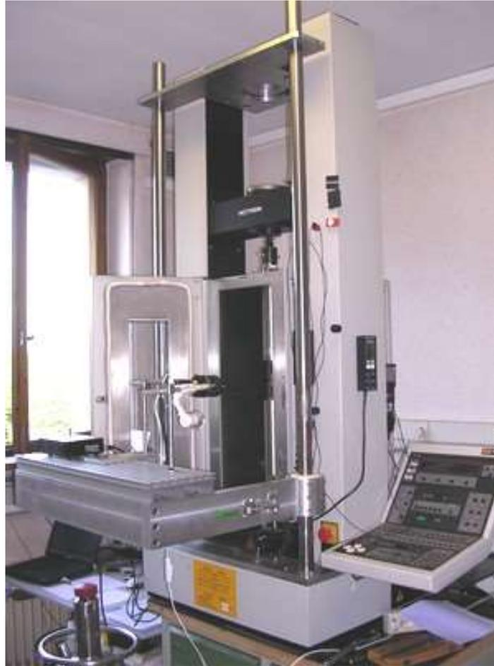
Figure 2.7. Machine de traction (10 KN) instrumentée à l'ICS-CNRS de Strasbourg.
