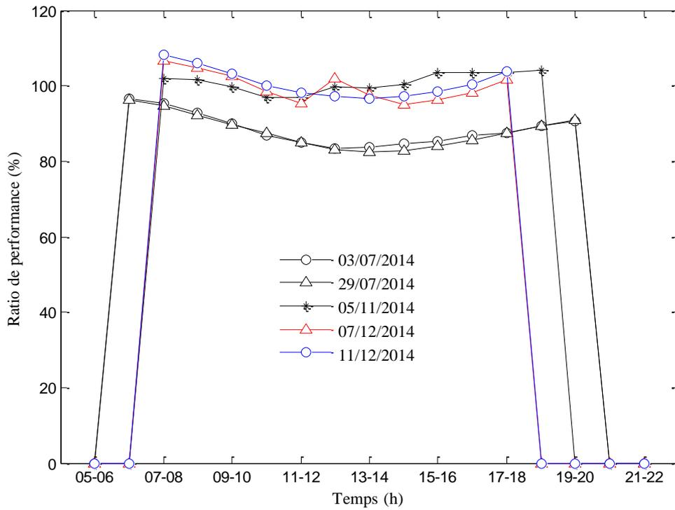
Figure 4.4. Le ratio de performance horaire durant les cinq jours de tests.
