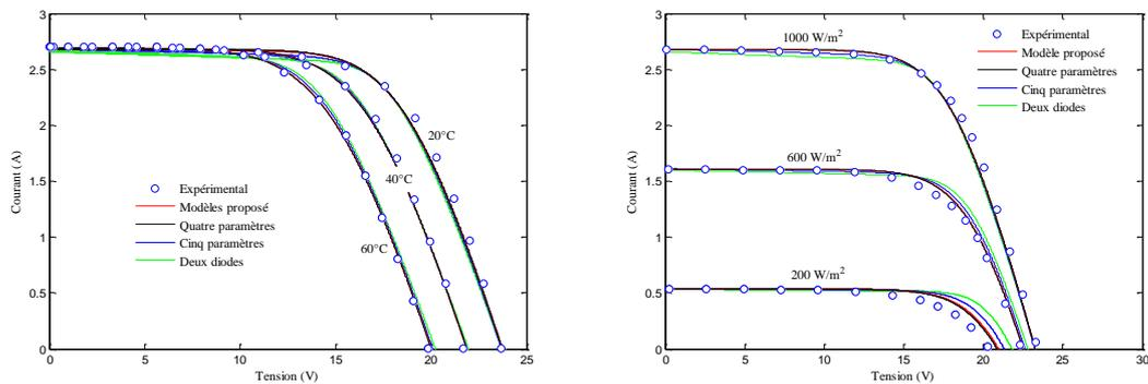
Figure 2. 11. Caractéristiques  $I$ - $V$  du module Shell ST40 pour différents éclairements et températures.
