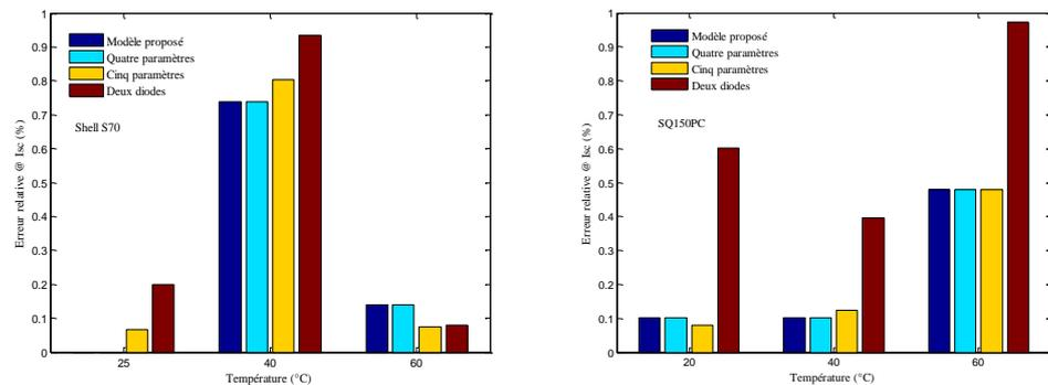
Figure 2.14. L'erreur relative pour  $I_{sc}$  des trois modules photovoltaïques pour différentes températures et à éclairage constant  $1000 \text{ W/m}^2$ .
