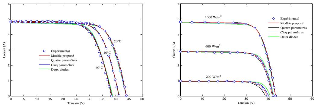
Figure 2.12. Caractéristiques  $I$ - $V$  du module SQ150PC pour différents éclairements et températures.
