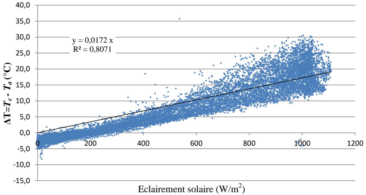
Figure 3. 7. La variation de  $\Delta T$ , en fonction de l'éclairement solaire et l'approximation linéaire des données pour le mois de juin 2014.
