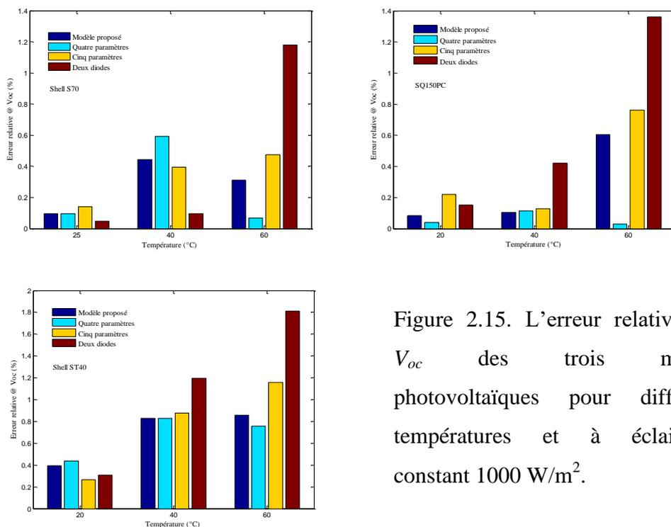
Figure 2.15. L'erreur relative pour  $V_{oc}$  des trois modules photovoltaïques pour différentes températures et à éclairement constant  $1000 \text{ W/m}^2$ .
