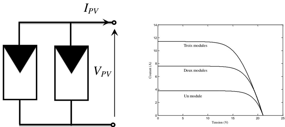
Figure 1.6. Association des modules photovoltaïques en parallèle.
