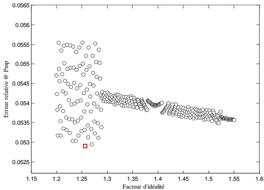
Figure 2.3. L'erreur relative du point de puissance maximale à différentes valeurs du facteur d'idéalité  $\gamma$  à STC pour le module BP MSX-60.
