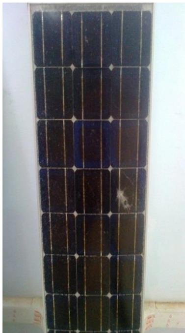
Figure 1.17. Exemple de rupture d'un module photovoltaïque.
