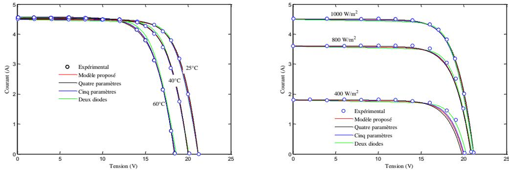
Figure 2. 10. Caractéristiques  $I$ - $V$  du module Shell S70 pour différents éclairements et températures.
