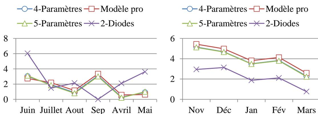
Figure 4.12. Erreur relative (%), de l'énergie moyenne mensuelle des quatre modèles.
