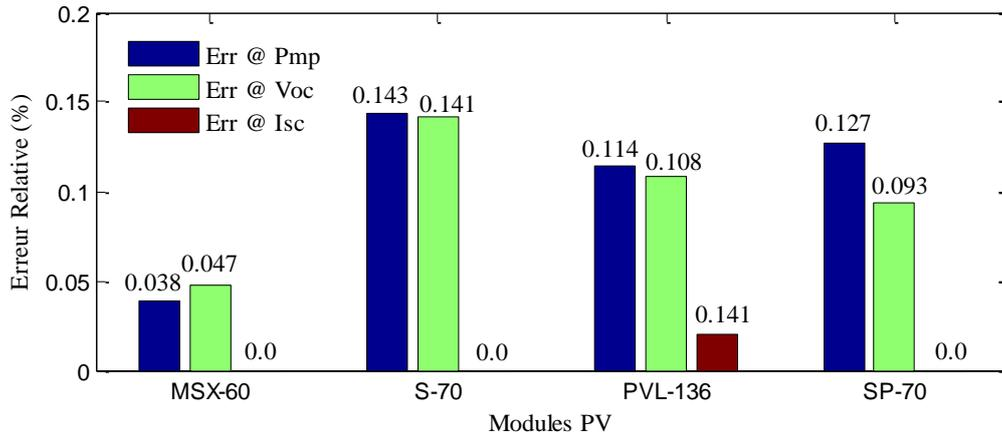
Figure 2. 9. Erreur relative de  $P_p$ ,  $V_{oc}$  et  $I_{sc}$  à STC.
