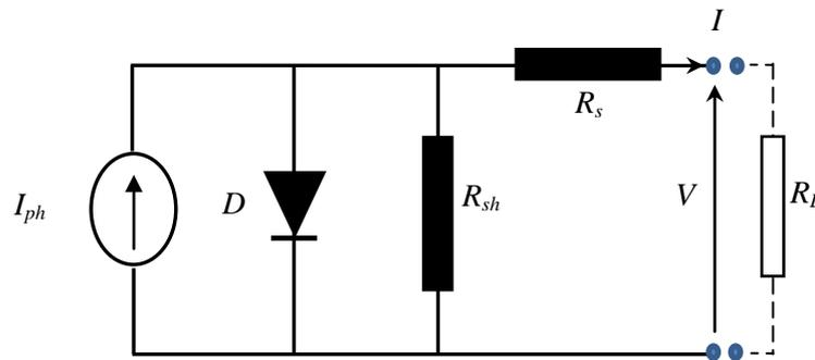
Figure 2.1. Circuit équivalent du modèle à cinq paramètres.
