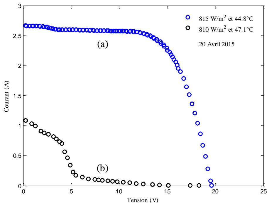
Figure 1. 18. Influence de différents types de dégradation sur la caractéristique  $I-V$  d'un module photovoltaïque, UDTS-50, (a) Délamination avec décoloration (b) Rupture de la vitre avec fissure et décoloration des cellules PV.
