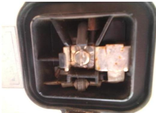
Figure 1.16. Exemple de la corrosion d'un module PV.
