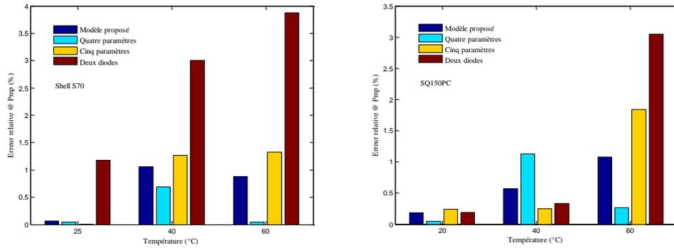
Figure 2.13. L'erreur relative pour  $P_p$  des trois modules photovoltaïques pour différentes températures et à éclairage constant  $1000 \text{ W/m}^2$ .
