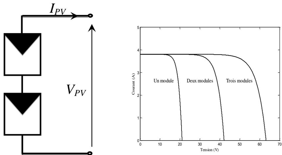
Figure 1.5. Association des modules photovoltaïques en série.
