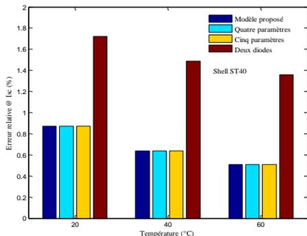
Les figures 2.13-2.15 présentes l'erreur relative de  $P_p$ ,  $I_{sc}$  et  $V_{oc}$  pour différentes températures et éclairement constant ( $1000 \text{ W/m}^2$ ).
