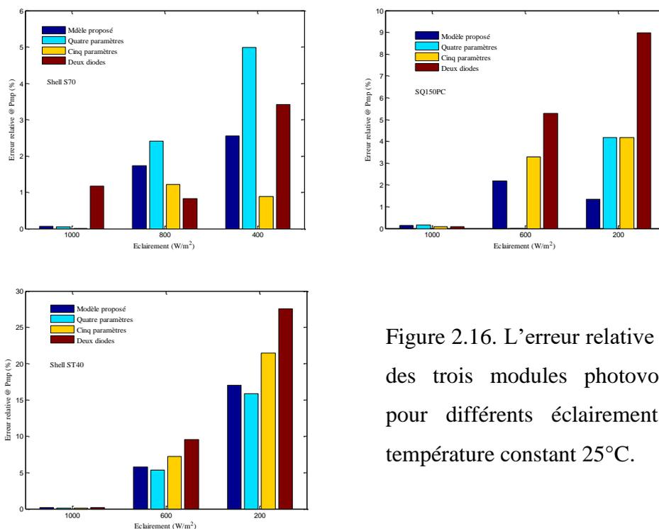
Figure 2.16. L'erreur relative pour  $P_p$  des trois modules photovoltaïques pour différents éclairagements et à température constant 25°C.
