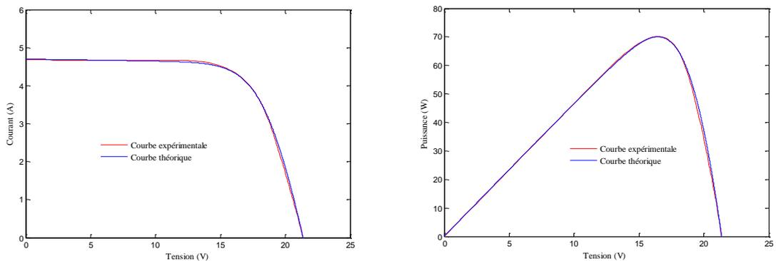
Figure 2. 8. Courbe  $I-V$  et  $P-V$  pour le module SP-70 en silicium monocristallin à STC.
