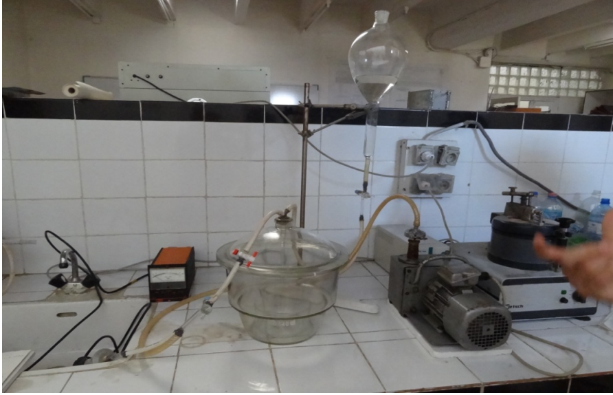
الشكل.10.II. المخطط التركيبي المستعمل لقياس نسبة الفراغات المفتوحة.
