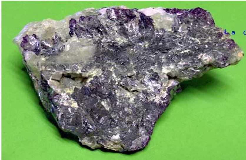
Figure I.1. Galène avec fluorite verte et calcite [15].
