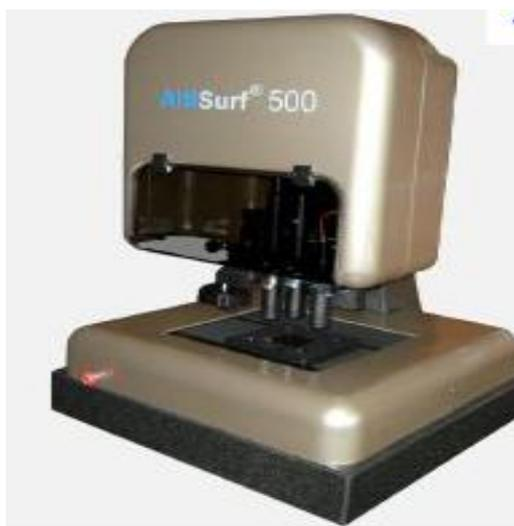
Figure II.2. Profilomètre AltiSurf 500 utilisé pour la mesure des épaisseurs de nos films.
