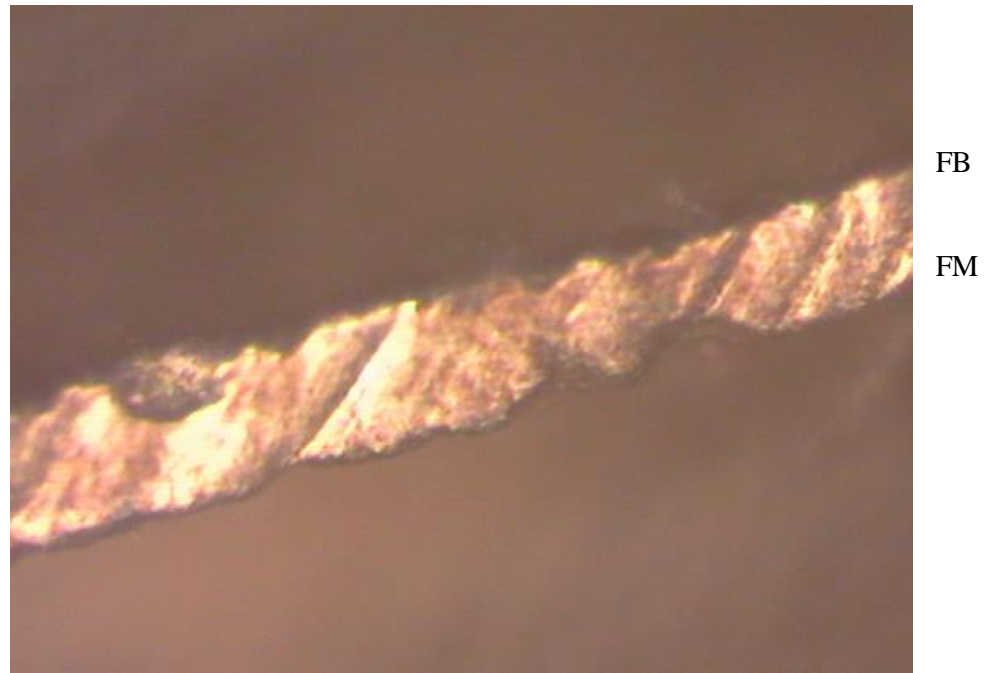
Fig. 17: Micrographie optique obtenue suivant la section du ruban Al-20 %Cu élaboré à 42 m/s.
