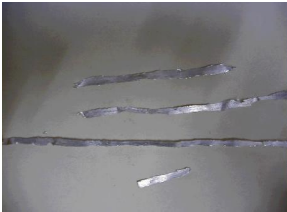
Fig. 18: Photographie des rubans élaborés par la méthode du melt-spinning pour l'alliage Al-5 %Cu refroidi à 31.5 m/s.
