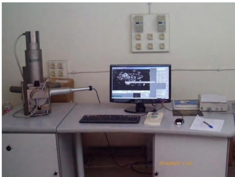
**Figure II.12 :** Microscope électronique à balayage (MEB)
