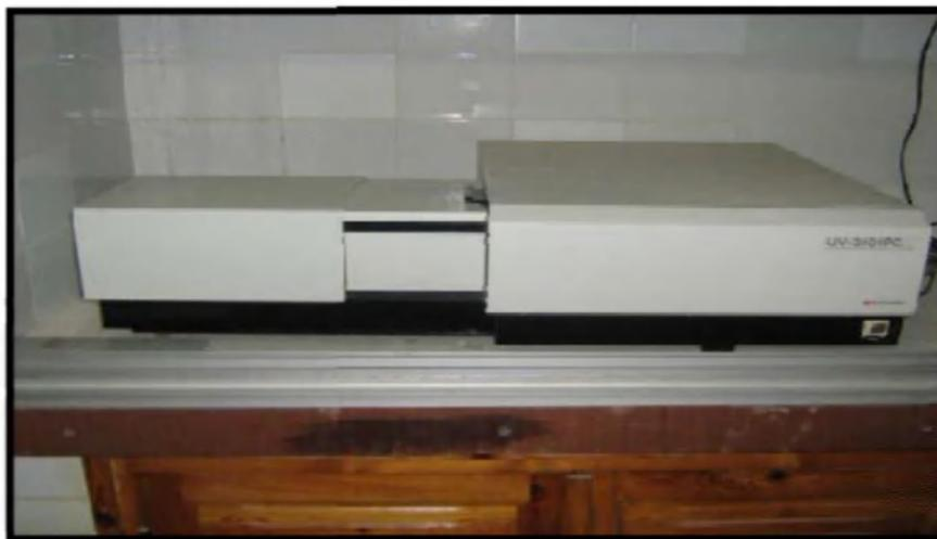
**Figure II.15 :** Photographie du spectrophotomètre UV- Visible (Shimadzu UV 3101 PC).
