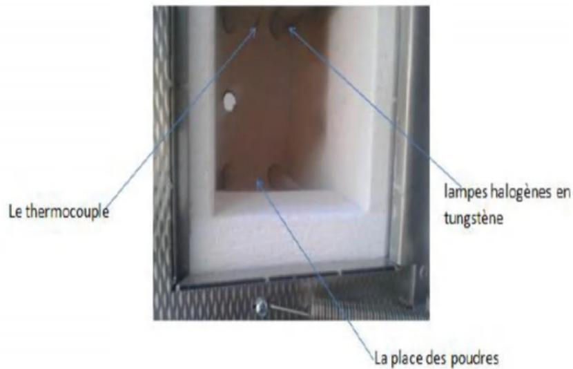
Figure III.13 : Four RTP avec l'emplacement des lampes infrarouges et l'emplacement des échantillons.
