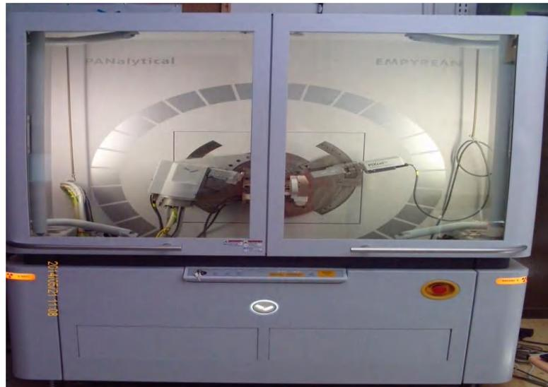
Figure II.7 : Diffractomètre de type (PANalytical)
