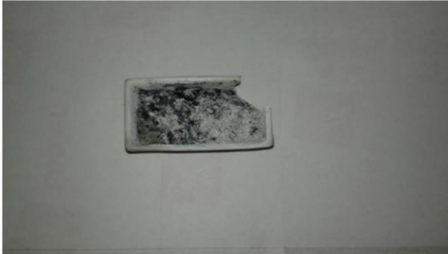
**Figure III.16** : Creuset en céramique fracturé après exposition à une puissance MW de 800W.
