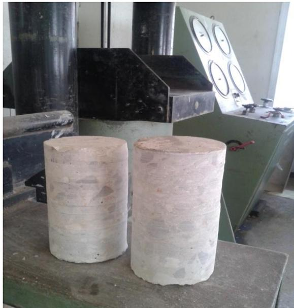
**Figure III.9** Presse hydraulique et échantillons cylindriques
