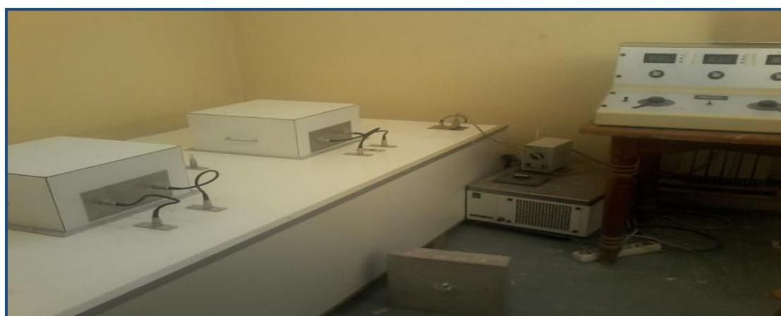
**Figure III.6** Cellule de mesure de la méthode des boîtes
