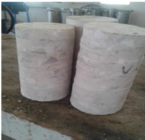
**Figure III.4** Les échantillons pour essais mécanique
