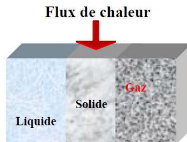
Figure I.11 : Représentation du modèle parallèle
