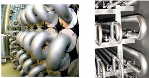
Figure (1.4) :L'échangeur tubulaire AC titube.
