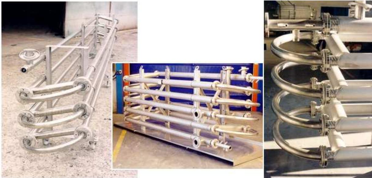
**Figure (1.5) : Echangeurs coaxiaux utilisés en vinification.**
