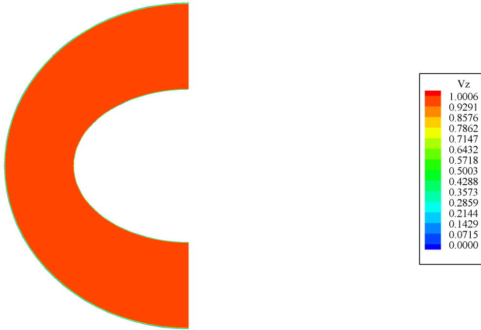
Fig. 13. Vitesse axiale à la section de sortie de l'espace annulaire. Re = 200 .
