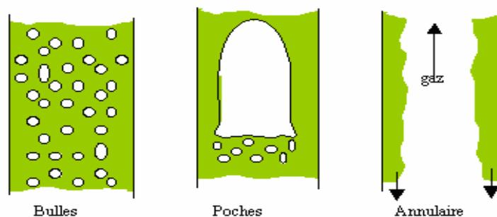
**Figure I.4 :** Régimes d'écoulement gaz-liquide.
