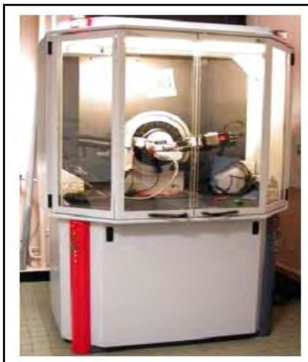
*Figure II.8 : Diffractomètre de marque BRUKER –AXS type D8*
