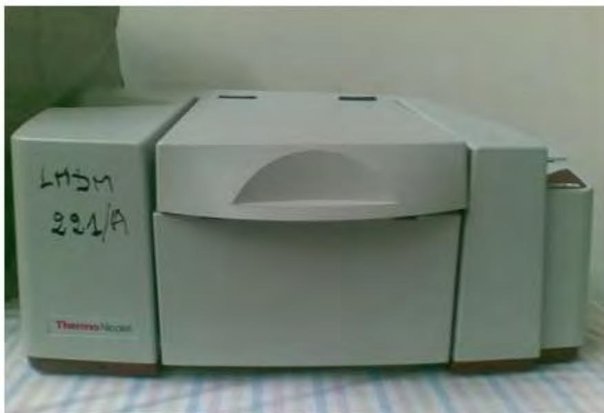
*Figure II.11: Spectromètre Infrarouge.*
