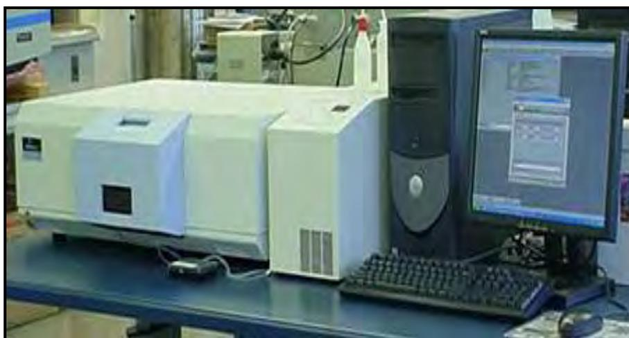
*Figure II.12.1 : Spectromètre de luminescence Perkin Elmer LS 55*
