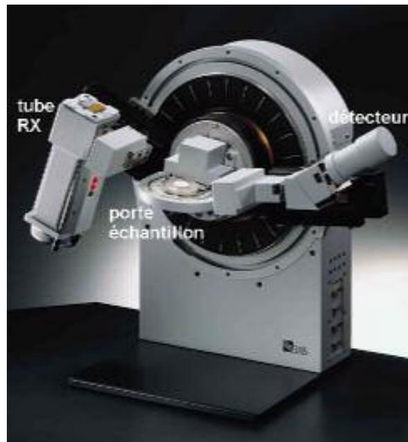
**Fig. III.5** Goniomètre de la marque Bruker-AXS, type D8
