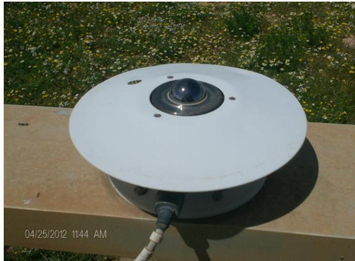
**Figure III.12:** Pyranomètre
