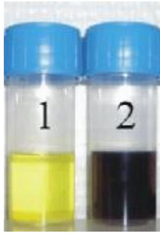
Figure I-12: L'image montre une solution de sel d'or (1) et une solution de nanocristaux d'or (2)
