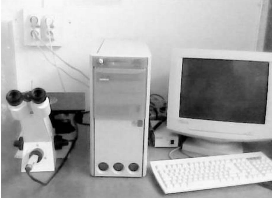
*Figure III.6 Microscope optique utilisé est de type AXIVERT 25CA.*
