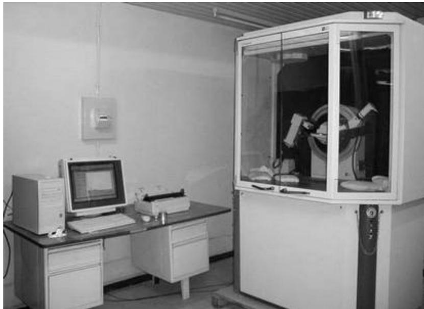
Figure III.4 Le diffractomètre utilisé est de type Siemens D8 Advance
