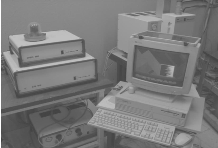
Figure III.1 la calorimétrie différentielle à balayage utilisé est de type SETARAM DSC92
