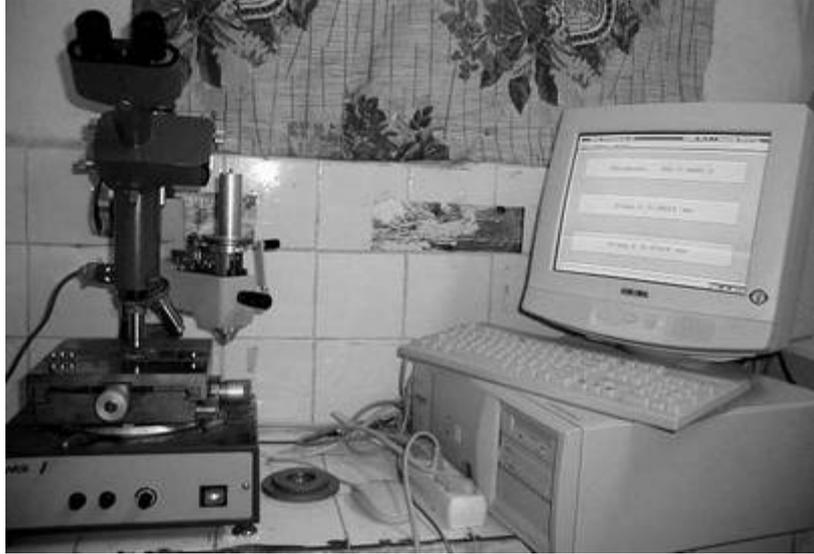
Figure III.2 Le microduromètre utilisé est semi-automatique de type ZWICK à pénétration
