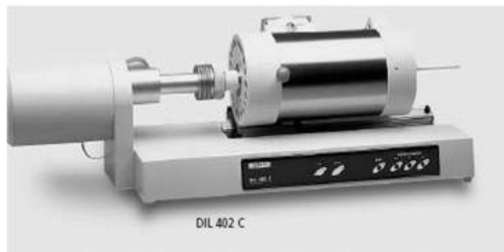
Figure III.5 Le dilatomètre utilisé est de type DIL 402C NETTZSCH4
