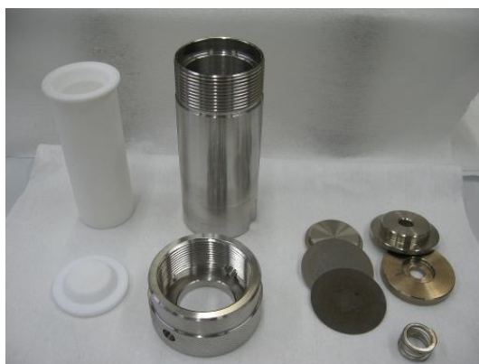
Figure II.2 Image représentant les différentes pièces d'une bombe hydrothermale.
