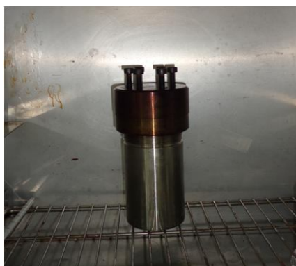
Figure II.5 Bombe hydrothermale dans l'étuve- étape 2.
