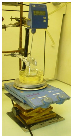
Figure II.4 Montage du polissage chimique des plaques du titane dans l'acide oxalique.
