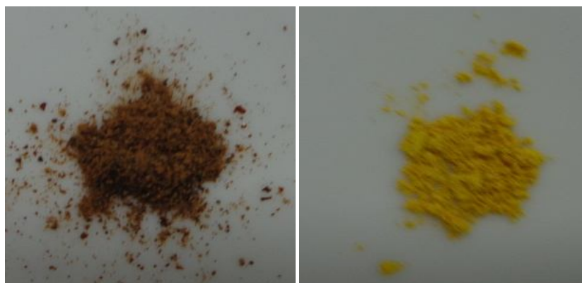
Figure II.21 Photos des poudres de ZnS et de CdS obtenues après centrifugation.
