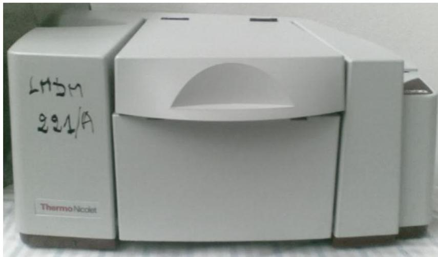
*Figure III.11. Spectromètre Infrarouge du laboratoire de microstructures et défauts dans les matériaux (LMDM).*
