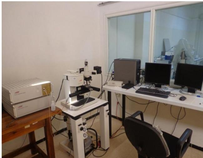
Fig. II.21 : Nanoduromètre. (Bruker AXS BW/508/98/RÖ CSM)
