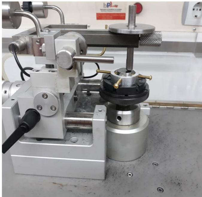
Fig. II.22 : Image de Tribomètre utilisé dans nos tests
