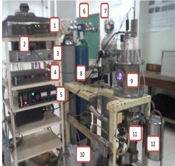
Fig. II.9 : Bâti de pulvérisation magnétron.
