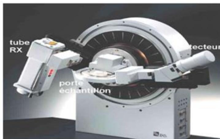
*Figure II.13: Modèle de goniomètre de type Brucker-AXS-D8*
