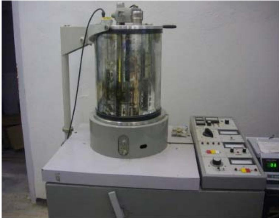
**Fig. II. 2** : Montage expérimental de la technique d'évaporation thermique sous vide, laboratoire des couches minces et interfaces de l'université des frères Mantouri, Constantine
