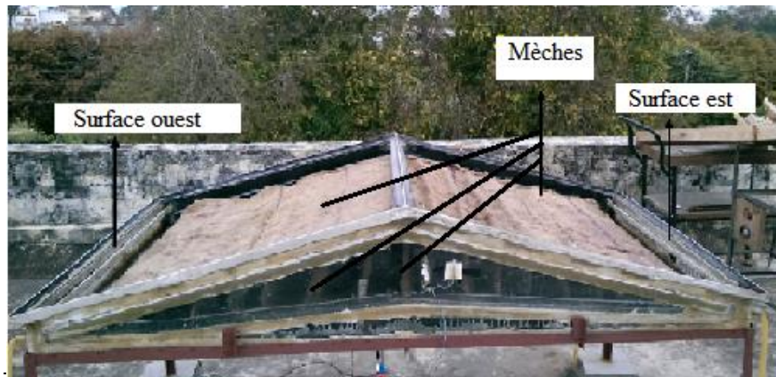
Figure III.19 Distillateur solaire multi-mèches à double effet.
