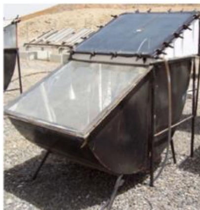
Figure II.16 Distillateur solaire à absorbeur inversé avec un réflecteur courbé externe.
