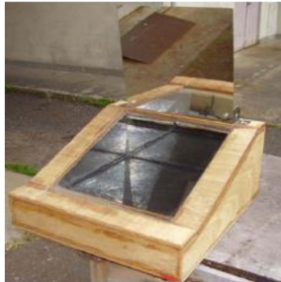
Figure II.19 Distillateur solaire avec des miroirs internes et externes.
