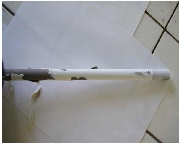
**Figure II.8.** : Vue de nanopoudres collectées sur le filtre céramique nanoporeux à droite et par condensation sur le doigt froid à gauche.
