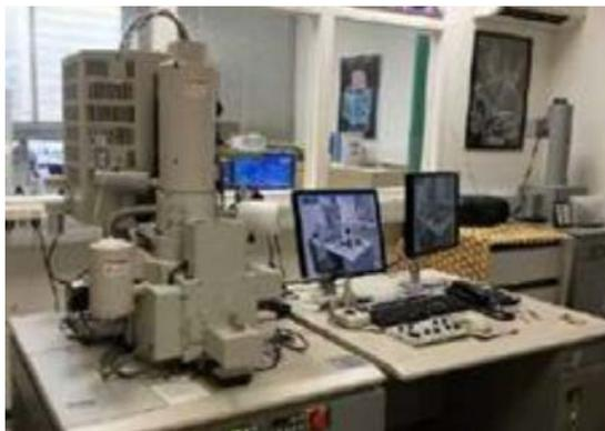
**Figure II.30** : Microscope électronique à balayage (Hitachi, S-4800).
