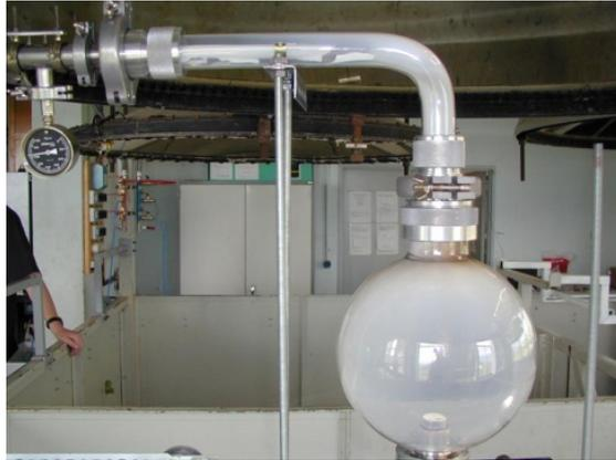
**Figure II.7.** dépôts sur le filtre et sur le ballon après une manipulation de vapo-condensation.
