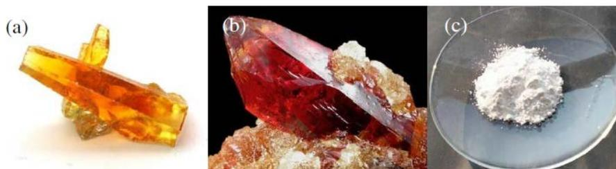
**Figure I.8 :** Oxyde de zinc (ZnO) : (a, b) sous forme naturelle et (c) sous forme artificielle provenant d'une synthèse sol-gel
