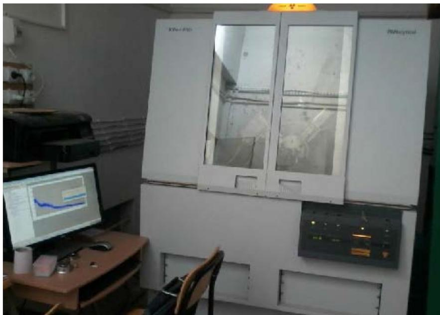
**Figure II.21** Diffractomètre de type (Panalytical X'PERT PRO)
