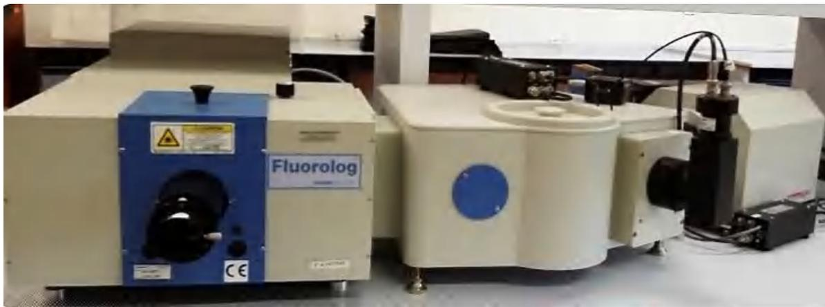
**Figure II-12.** Photo d'un montage de photoluminescence
