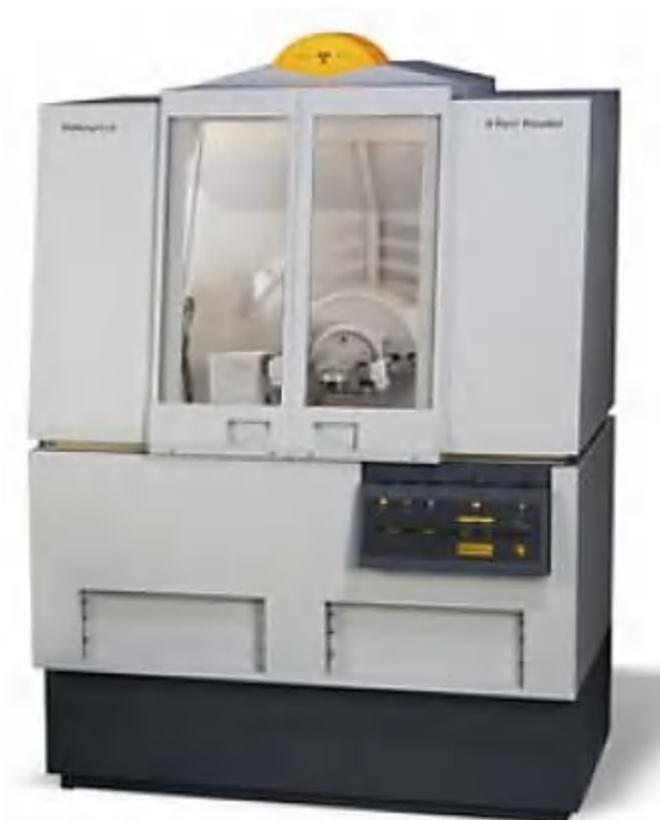
**Figure II-1.** Photographie d'un diffractomètre de type XPERT-PRO
