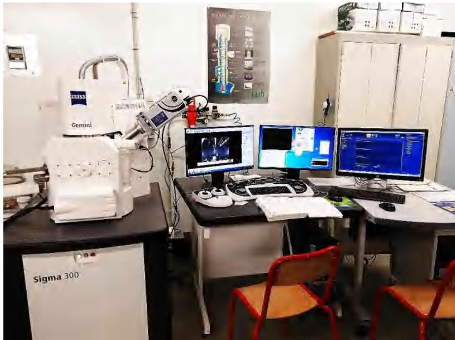
**Figure II-10.** Photo d'un montage Microscope Electronique à Balayage (MEB) type ZEISS
