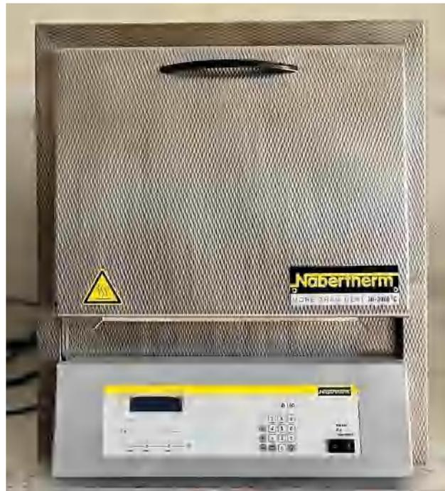
**Figure** Erreur ! Il n'y a pas de texte répondant à ce style dans ce document. **I-2.** Photo du four à moufle utilisé pour la calcination des échantillons
