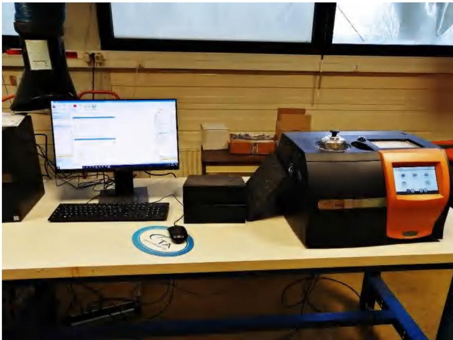
**Figure II-13.** Photo d'un montage de DSC
