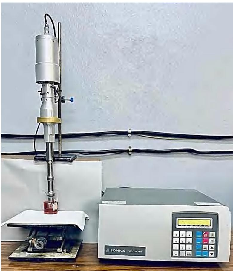
**Figure** Erreur ! Il n'y a pas de texte répondant à ce style dans ce document.**I-1.** Photo montrant la synthèse de l'échantillon (S1) à l'aide d'un sonde ultrasonique
