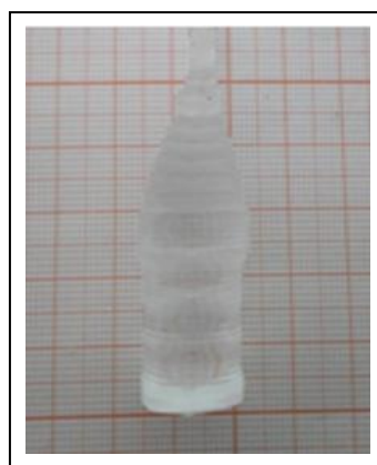
Fig.II.4.b : Monocristal de KBr dopé Nb
