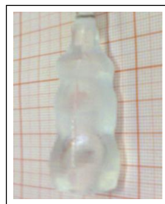
Fig.II.4.c : Monocristal de KCl dopé Nb
