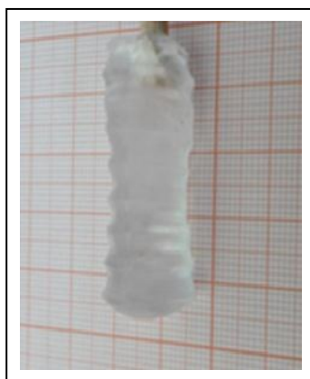
Fig.II.4.a : Monocristal de KBr pur
