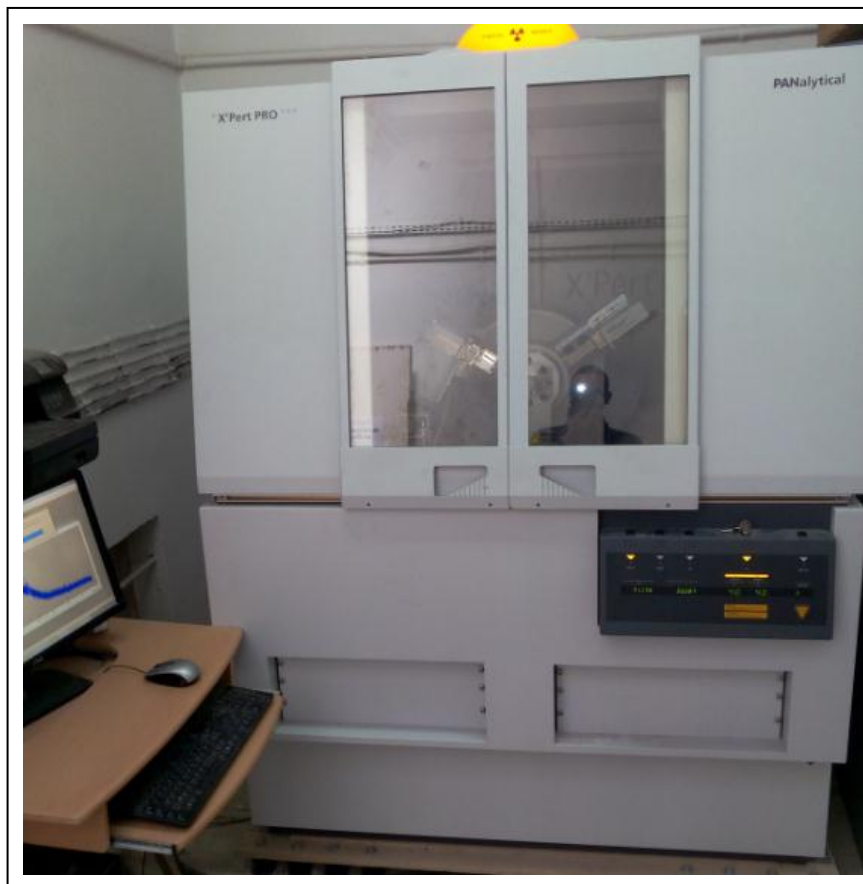
Figure III.3. Photographie du diffractom tre X Pert PRO (Universit  des Fr res Mentouri)
