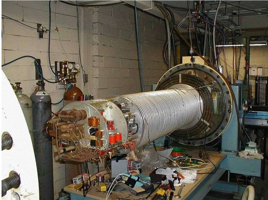
Figure II.18. Accélérateur de particules linéaire Van de Graaff (2 MeV); ici ouvert pour entretien.
