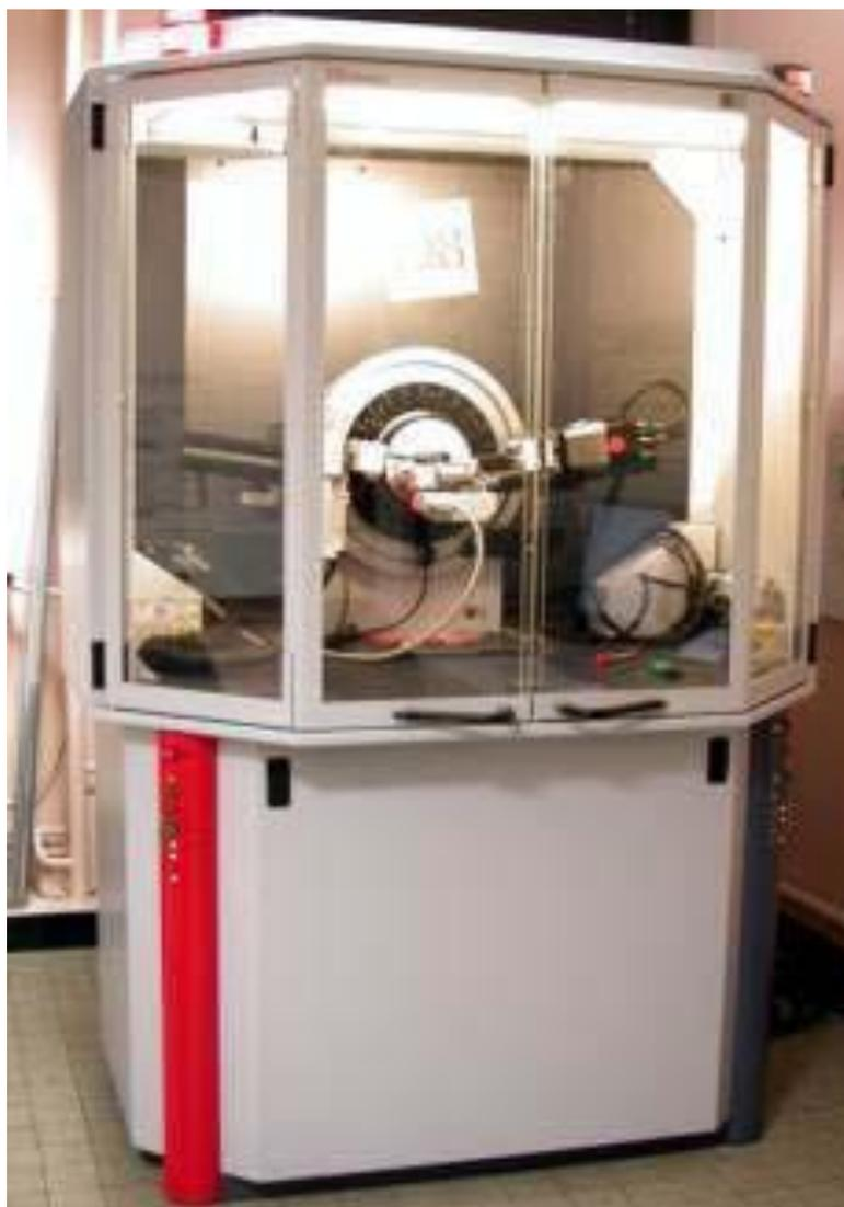
**Figure II.6.b** : diffractomètre de marque BRUKER - AXS type D8.
