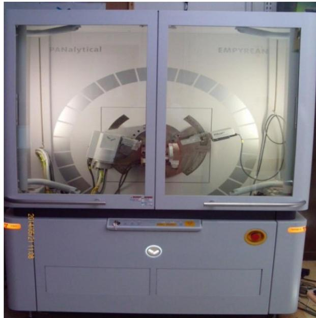
Figure II.9 : Diffractomètre de type (PANalytical)
