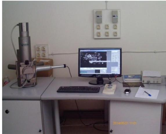
**Figure II.13: Microscope électronique à balayage (MEB)**
