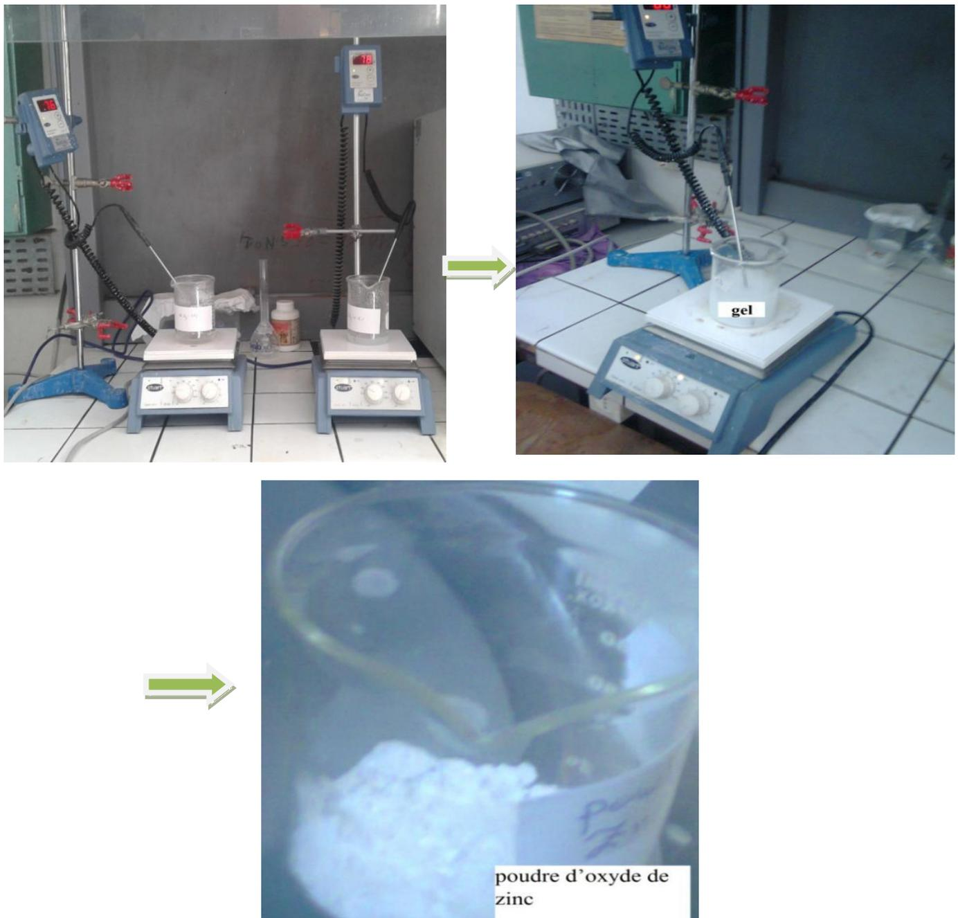
**Figure II.7** Le dispositif expérimental utilisé pour la préparation des poudres par la voie sol-gel
