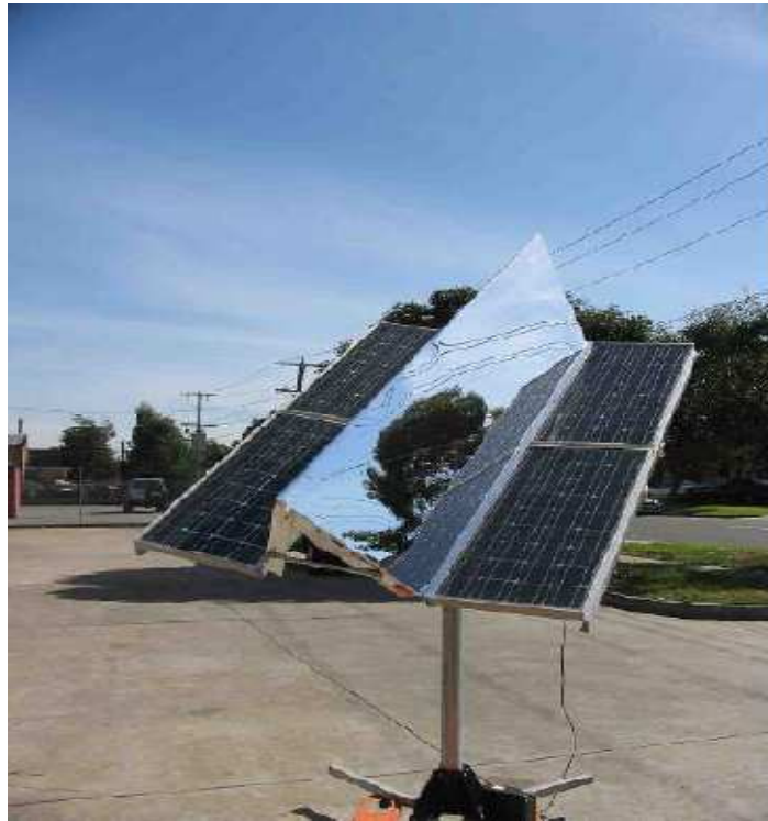
Figure 3.15 : Panneau solaire photovoltaïque avec miroir plan.
