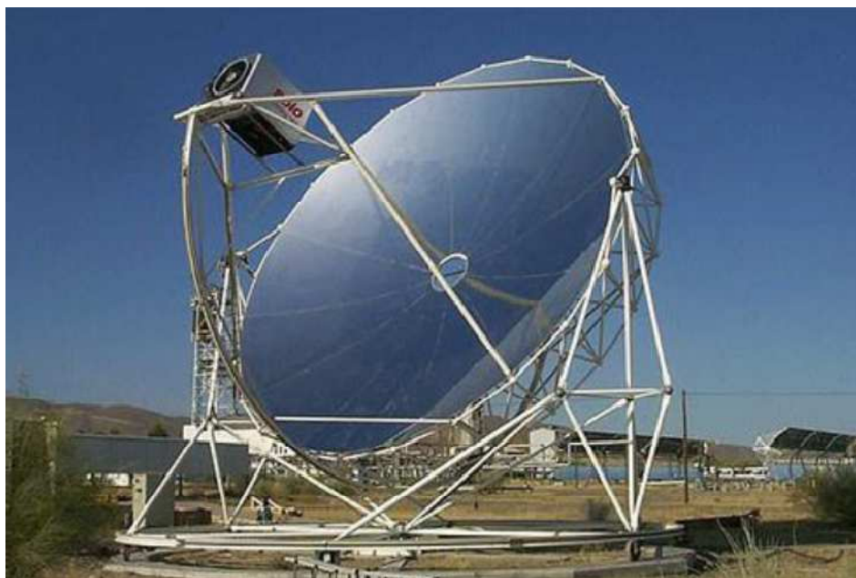
Figure 3.6: Miroir parabolique avec moteur Stirling [64]
