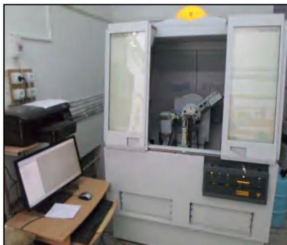
**Figure II.14:** Diffractomètre du type PANalyticalX'pert PRO
