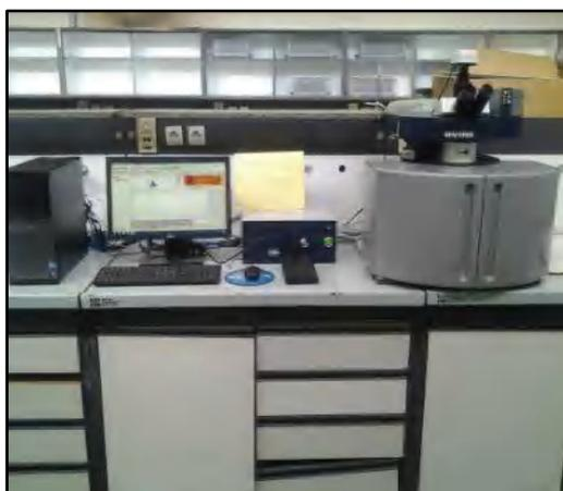
**Figure II.17:** Spectrophotomètre Raman
