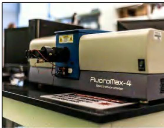
**Figure II.20:** Photographie du spectromètre de photoluminescence
