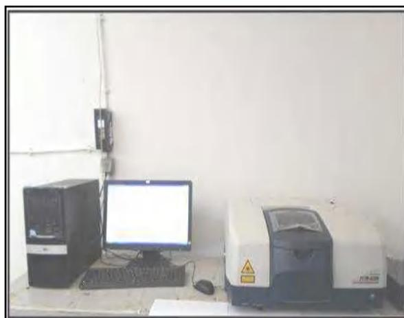
**Figure II.15:** Spectrophotomètre du type JASCO 6300
