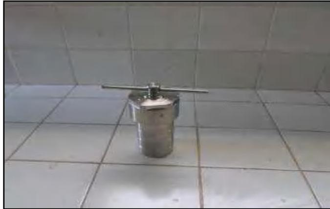
**Figure II.8:** Autoclave cylindrique utilisé pour la synthèse de  $\text{MnO}_2$ .
