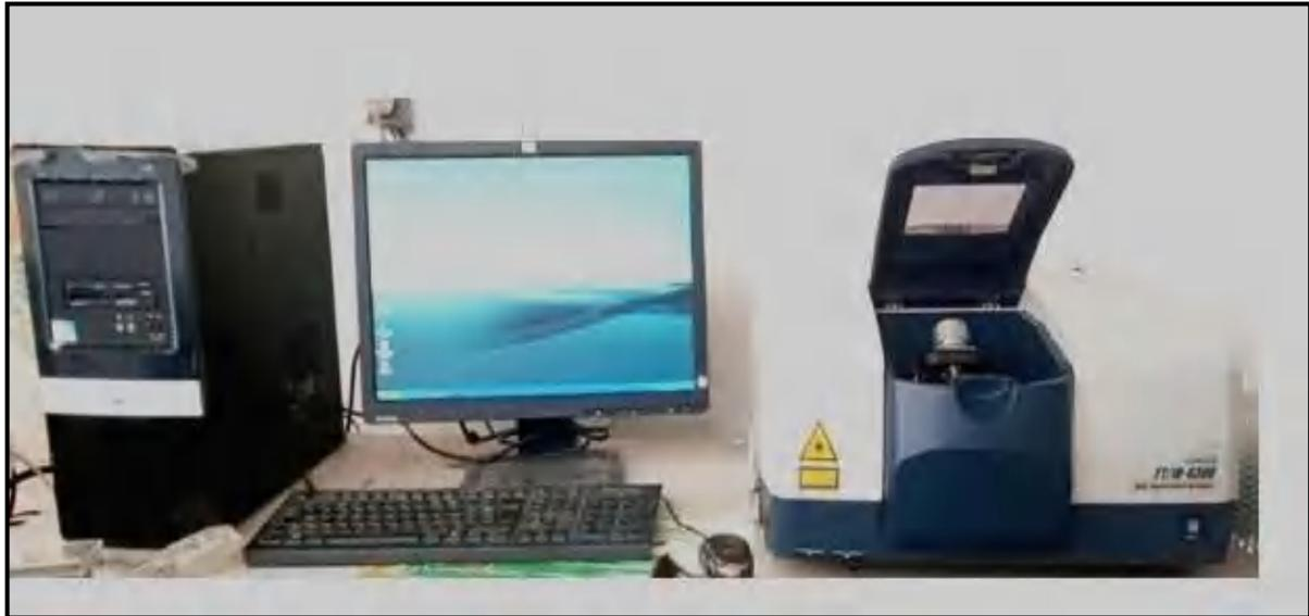
**Figure I.5:** Spectromètre à transformée de Fourier de type Jasco (FT/IR-6300) utilisé dans ce travail (Laboratoire de Cristallographie, Université Constantine1, Algérie).
