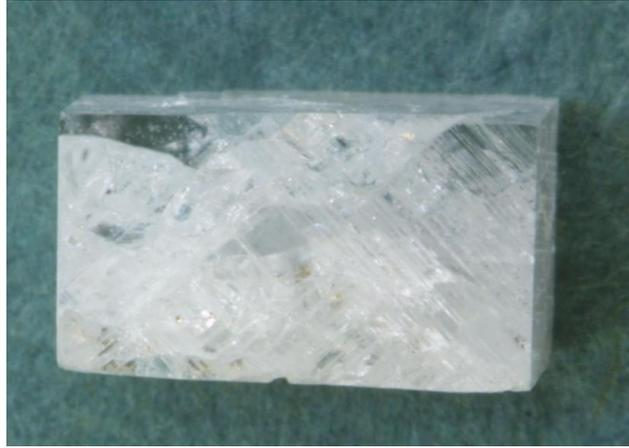
**Figure 3-16 :** Micrographie optique de l'échantillon monocristallin après déformation. Des bandes de glissement dans différentes directions sont observées ainsi que de nombreuses microfissures. La présence de fissures ne permet pas de mesurer l'angle entre les bandes de glissement afin d'identifier le type de glissement.
