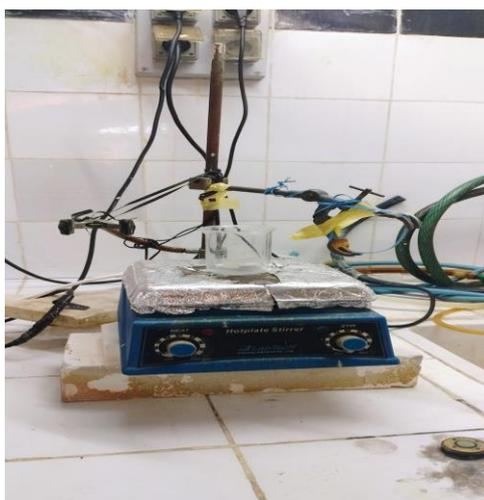
**Figure II.2 :** Plaque chauffante à agitation magnétique
