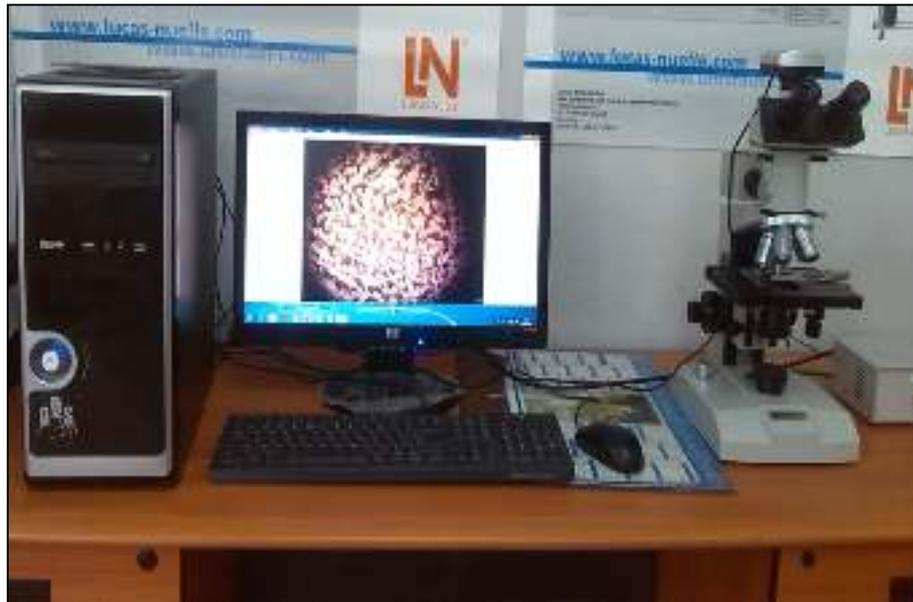
**Figure II. 5 : microscope métallographique OPTIKA B-383 PL.**
