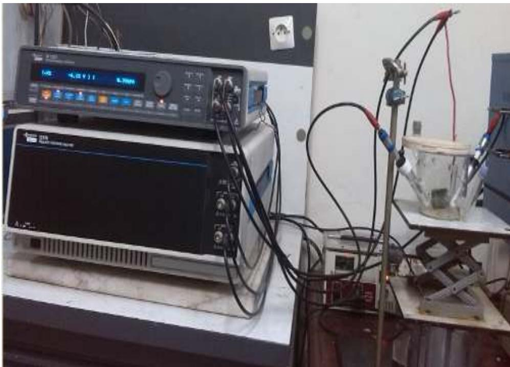
Figure II. 13 : montage pour essais électrochimiques.
