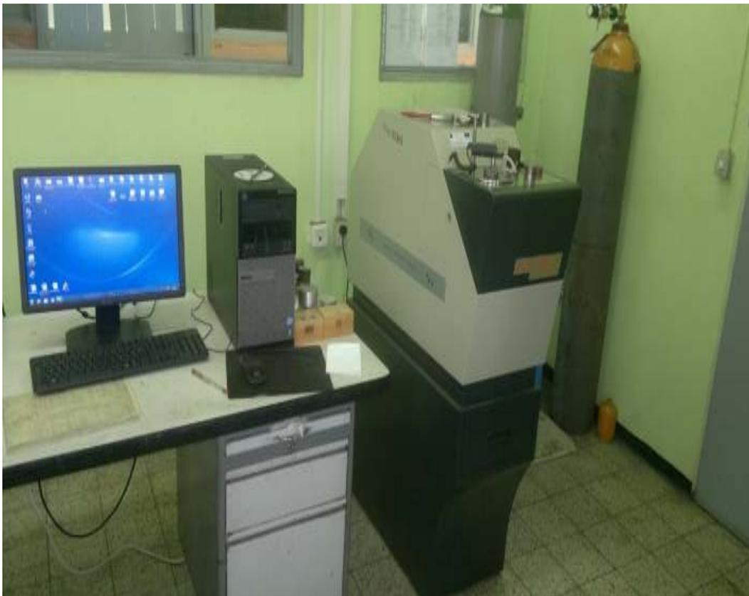
Figure II. 1 : spectromètre « [Solaris CCD Plus](#) » pour l'analyse des métaux ferreux et non-ferreux sur une base optique CCD (Charge Coupled Device).
