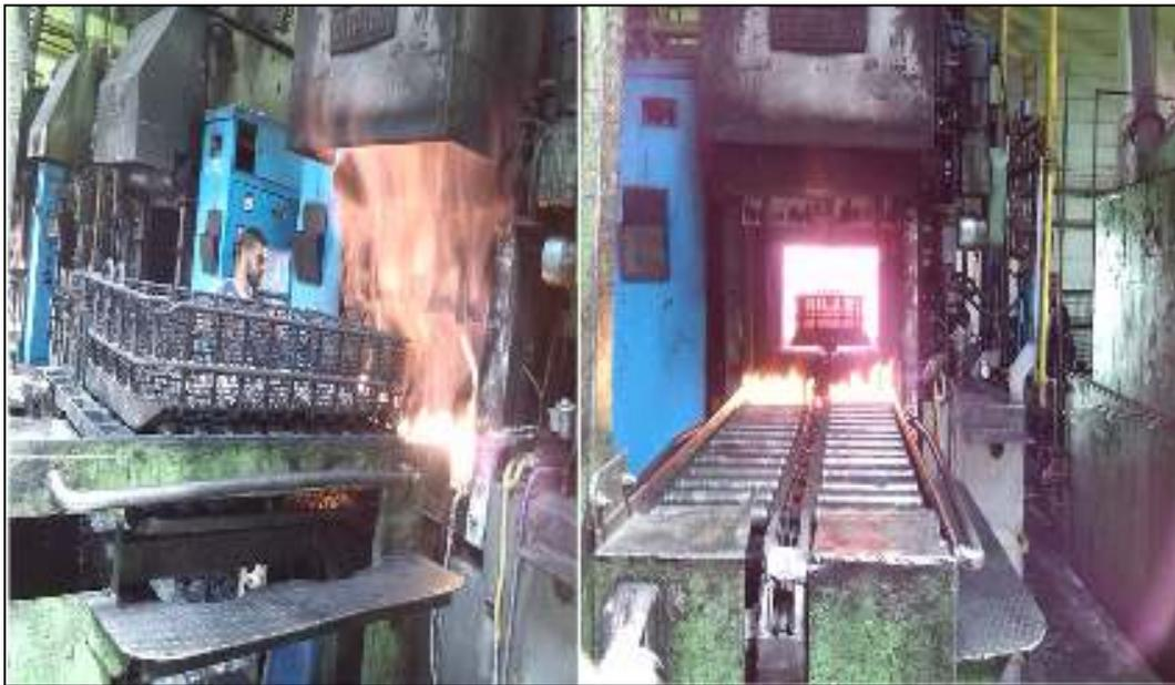
**Figure II. 2 : four « AICHELIN » pour la cémentation gazeuse –ETRAG-**
