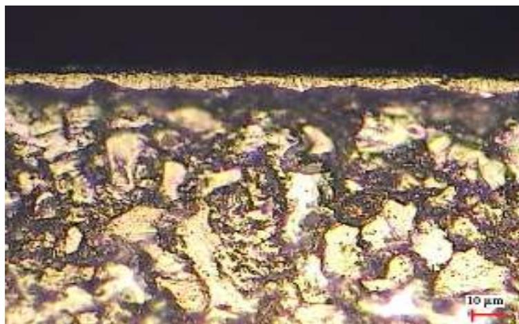
Figure III. 40 : micrographie de l'acier C15 nitruré
