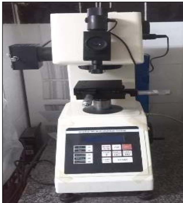
**Figure II. 9 : microduromètre semi automatique du type ZWICK à pénétration Vickers.**
