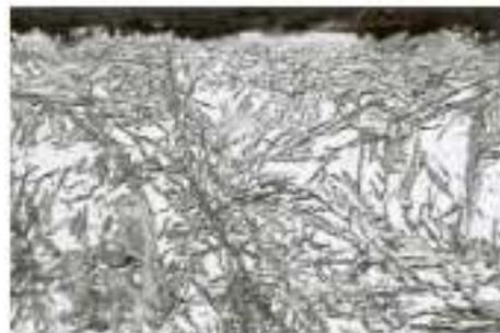
**Figure I. 7 : austénite résiduelle dans une couche cémentée et durcie par trempe [24].**
