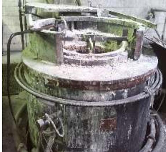
**Figure II. 4 : four à creuset métallique (bain de sels) pour le traitement de nitruration (T=580°C) -ETRAG-**
