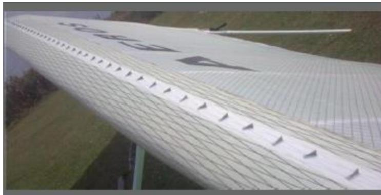
**Figure 2.2** Générateurs de vortex situés derrière le bord d'attaque de l'aile [53].
