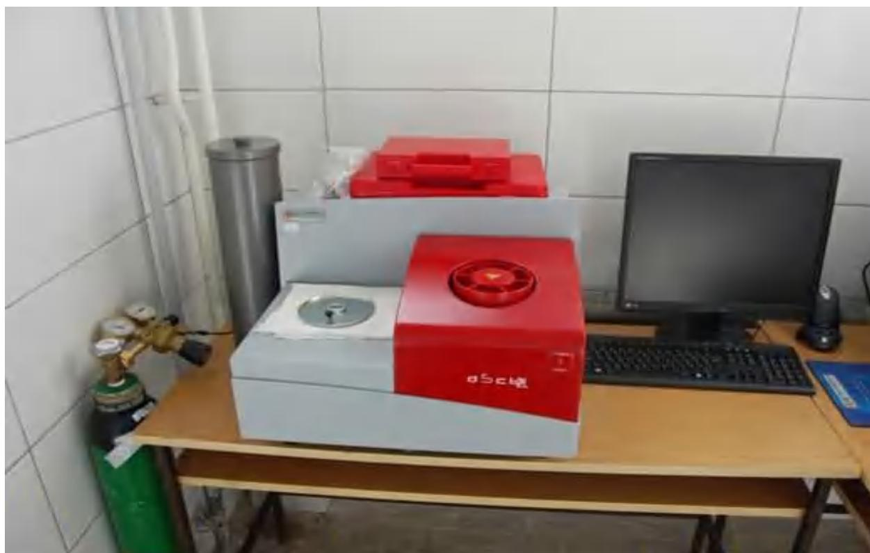
FIGURE II.11 – Calorimétrie différentielle à balayage utilisé dans cette étude.
