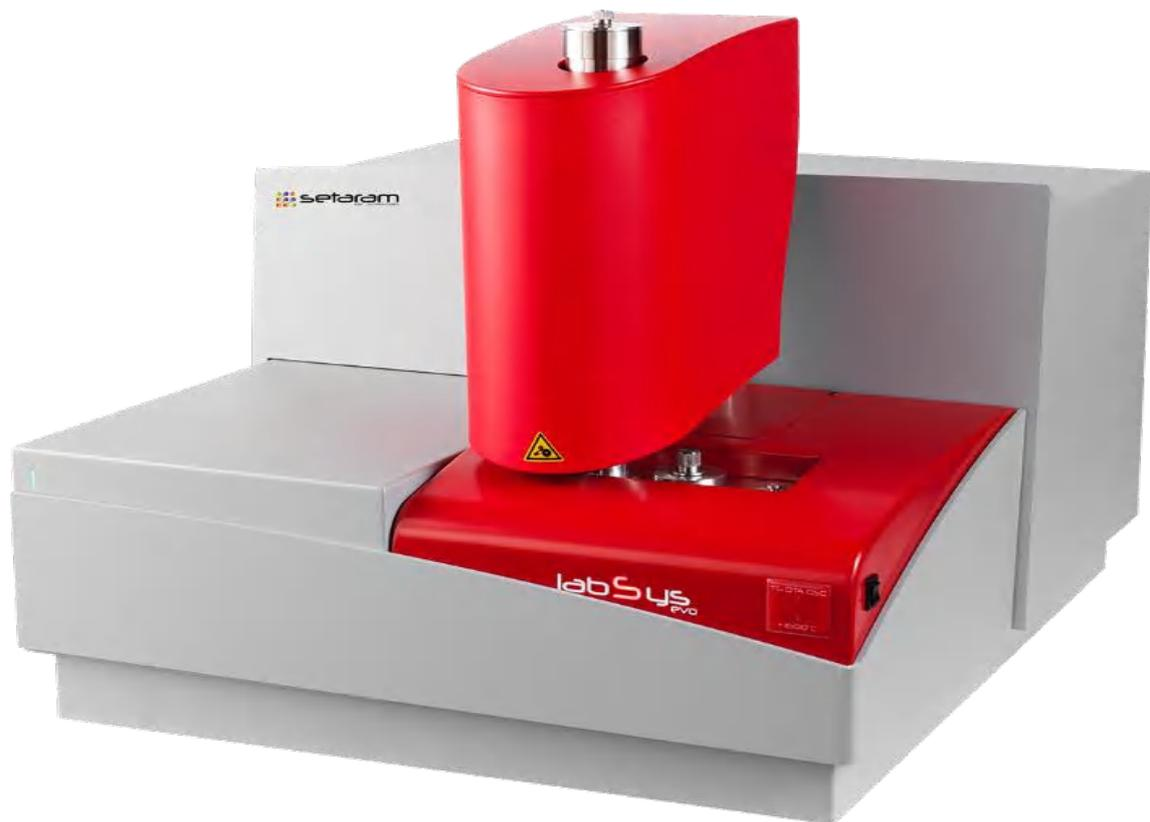
FIGURE II.13 – thermogravimétrie (TGA) utilisé dans cette étude.
