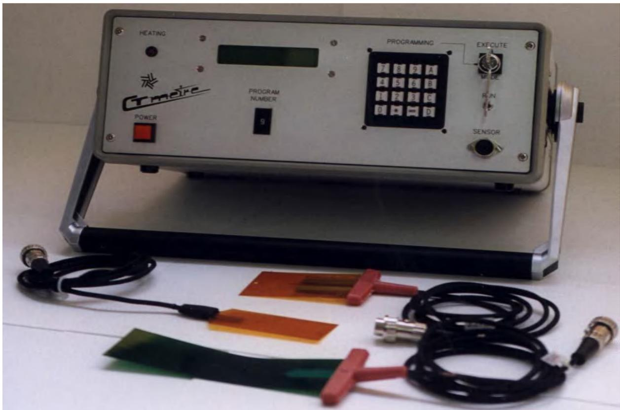
FIGURE II.18 – l'appareil de CT METER
