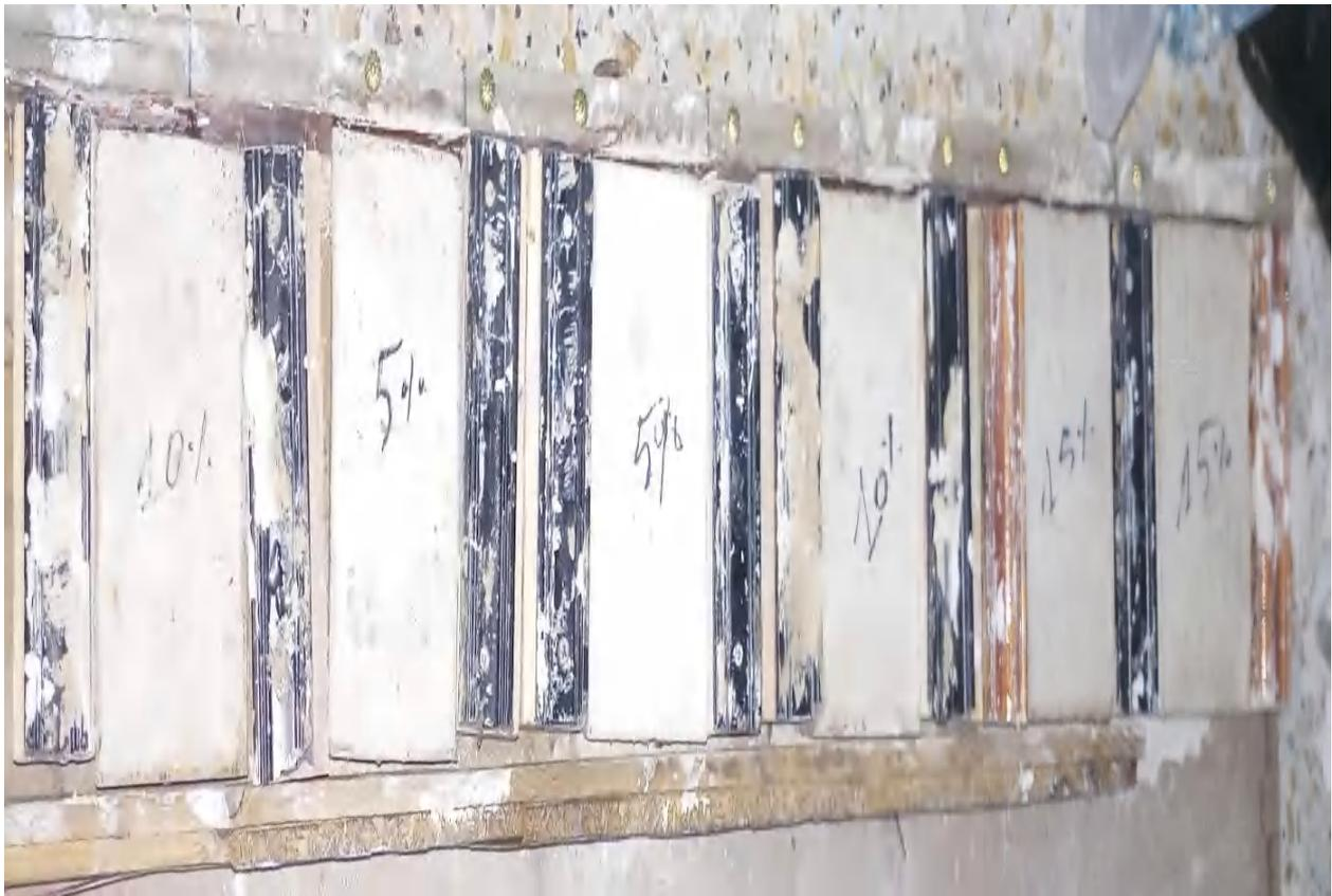
FIGURE III.3 – les échantillons dans le moules 16 × 8 × 4 cm.
