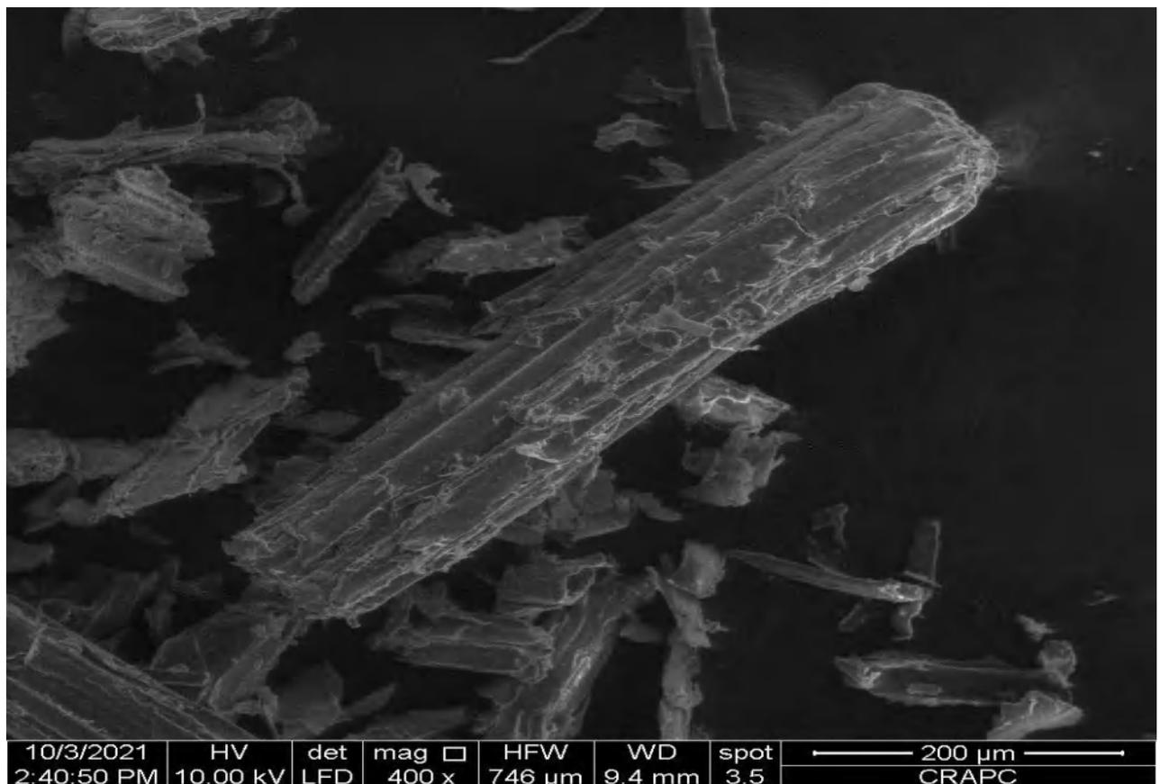
FIGURE I.5 – Images MEB d’une fibre de paille de blé.
