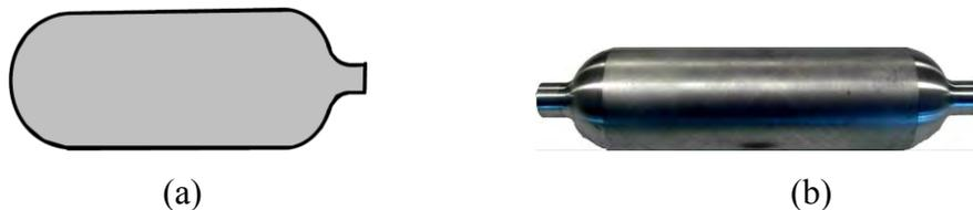
**Figure 2** : Illustrations du 4<sup>ème</sup> type des réservoirs : (a) schéma et (b) photographie
