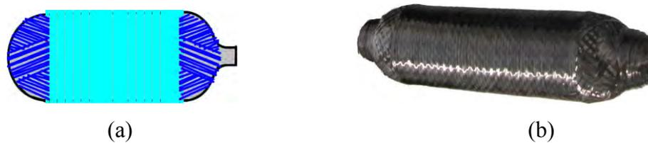
**Figure 4** : Illustrations du 3<sup>ème</sup> type des réservoirs : (a) schéma et (b) photographie
