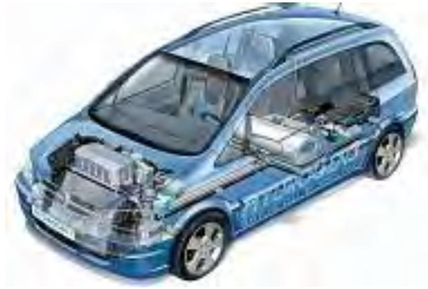
**Figure 7 :** Véhicule « HydroGen3 Compressed 700 » développé par General Motors équipé d'un système de stockage d'hydrogène comprimé. [23]
