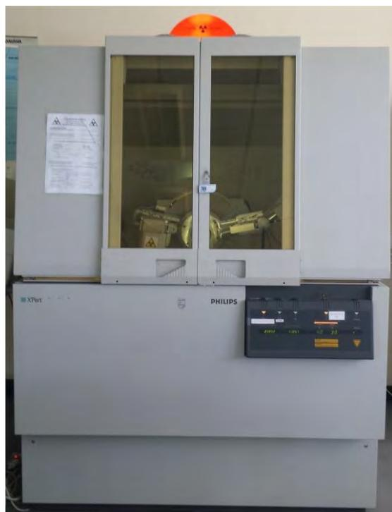
**Figure 37** : Photographie de l'appareil utilisé pour réaliser DRX.
