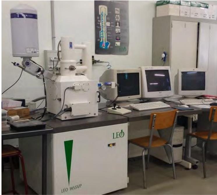
**Figure 34 :** Photographie de l'appareil MEB équipé d'un détecteur EDS.
