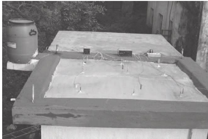
Fig.IV.8. Toiture avec MCP [92].
