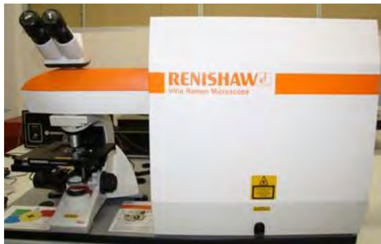
Figure II.17. Dispositif expérimental de l'appareillage (micro-Raman).
