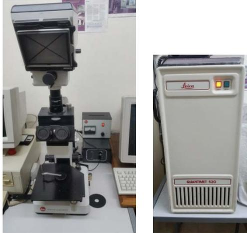
**Figure V.10:** Microscope optique Leitz METALLOVERT équipé par l'analyseur l'image Leica Quantimet-520.
