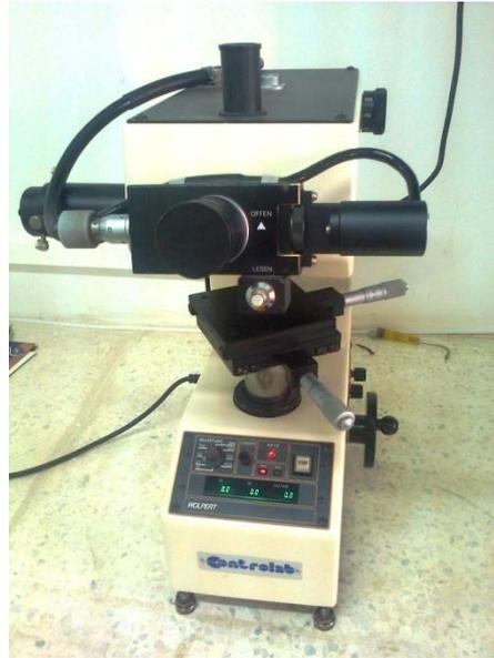
Figure V.18 : Microduromètre de type CONTROLAB à pénétration Vickers.
