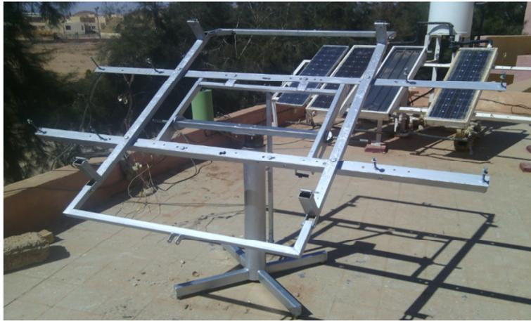
Figure V.3 porteur du capteur solaire
