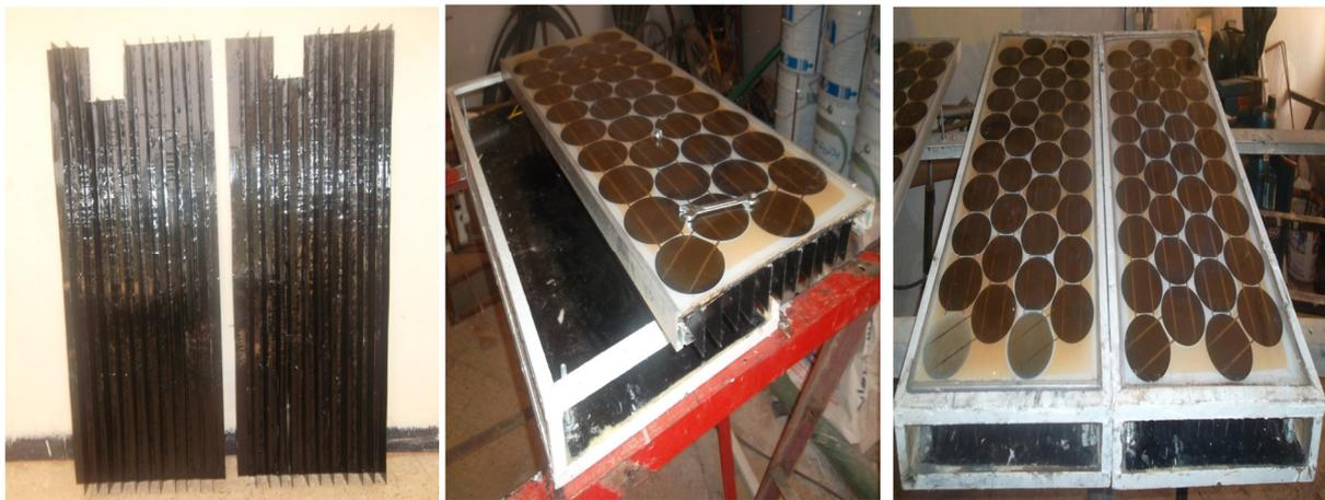
Figure V.2 éléments constituant le capteur PVT à air
