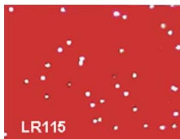
Figure (2.14): Traces de particules  $\alpha$  révélées dans les DSTN LR115
