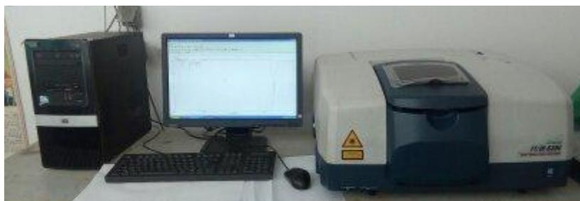
**Figure II.15 Photographie spectrophotomètre d'absorption infrarouge à transformé de Fourier**
