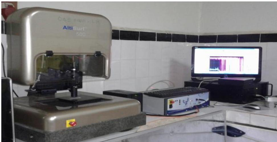
Figure II.11 Profilomètre Alti surf 500 utilisé pour la mesure des épaisseurs des films
