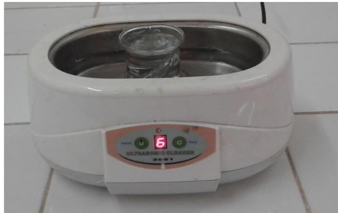
Figure II.6 Dispositif à ultrason de type ULTRASONIC CLEANER 3561
