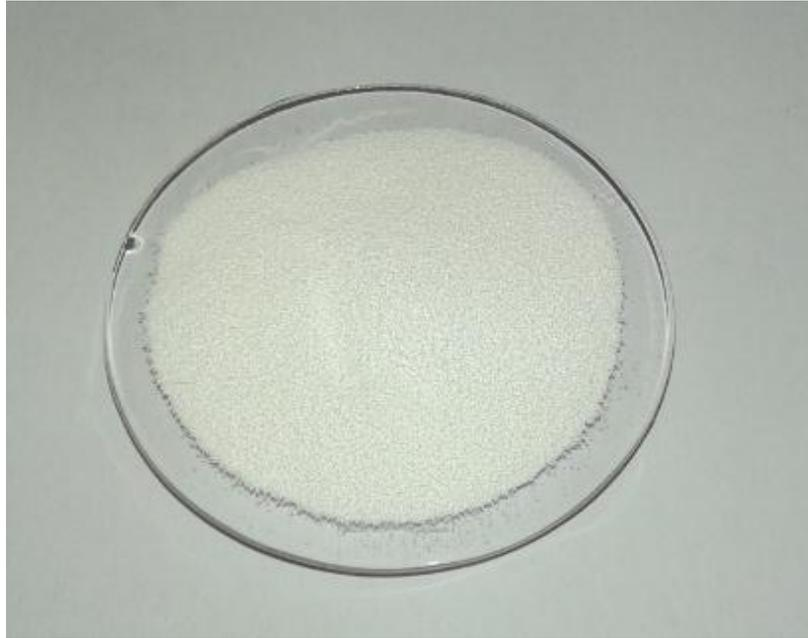
**Figure II.4 : La matière de PVC utilisée pour la préparation des nanocomposites**
