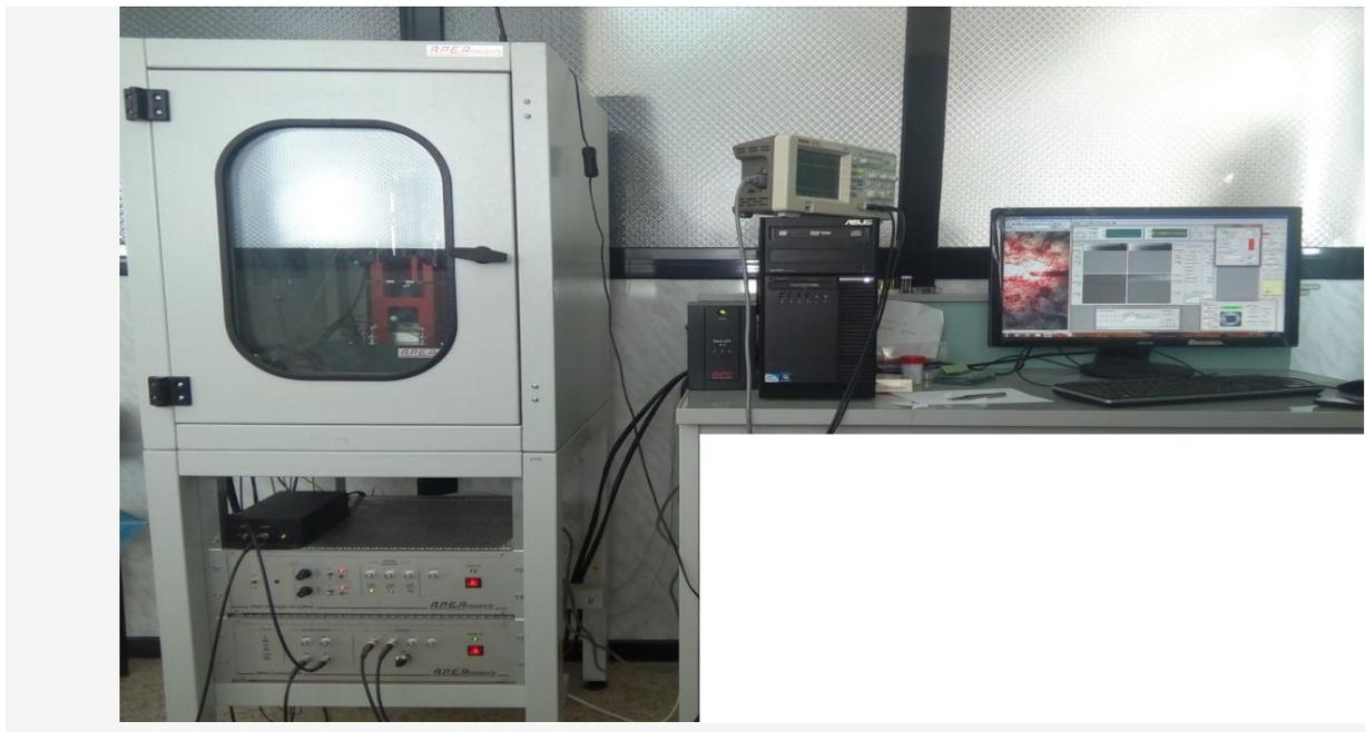
**Figure II.14 Photographie du microscope à force atomique A100-AFM avec système de contrôle SPM version 6.4.3. (Université d'Oum El Bouaghi)**
