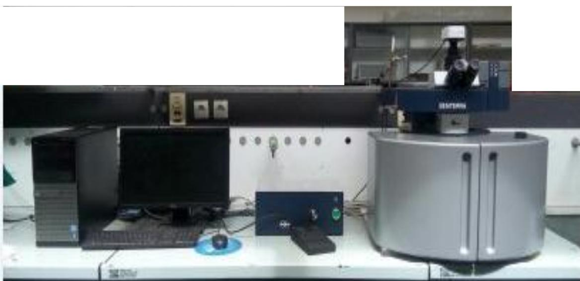
Figure II.16 photographie Spectromètre BRUKER Senterra micro-Raman
