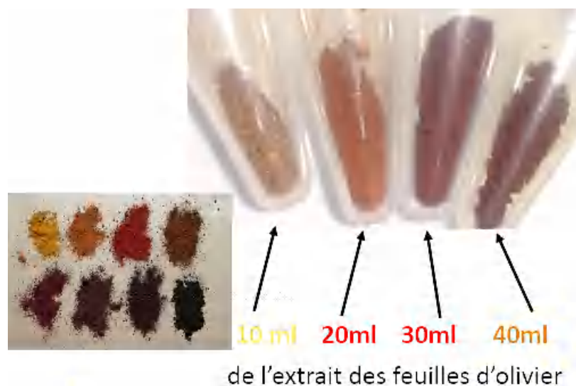
FIGURE 2.6 – Image photographique des poudres d'hydroxydes de fer synthétisés en fonction de la concentration d'OLE.
