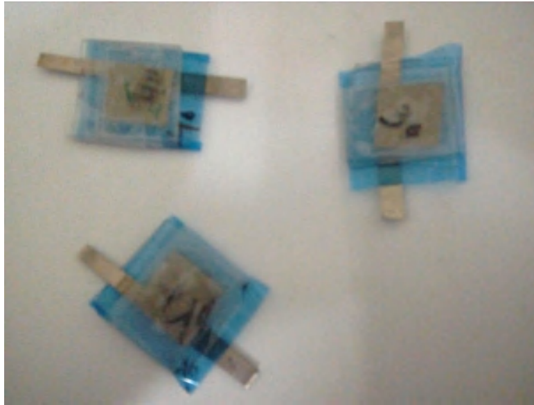
FIGURE 2.12 – Image photographique des dispositifs fabriqués avec AC/Fe_2O_3 sur Ti.
