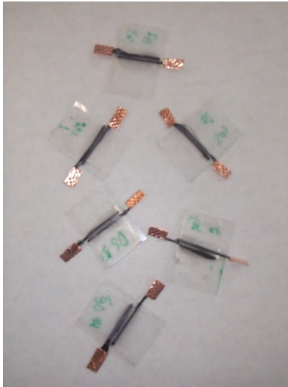
FIGURE 2.13 – Image photographique des électrodes fabriquées du composite AC/ Fe_2O_3 sur des fibres de carbone.
