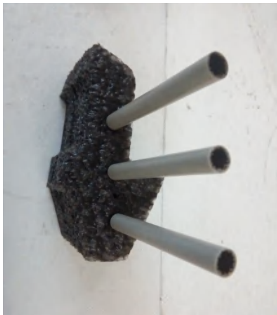
FIGURE 2.15 – Image photographique des électrodes de carbone en verre utilisés pour performer les tests électrochimique du composite rGO/ Fe_2O_3 .
